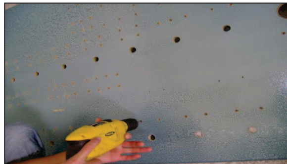
Foto 6.15: Perforación de los tableros Fuente: Módulo de Control Industrial Elaborado por: Cbos. Guanín Roberto
