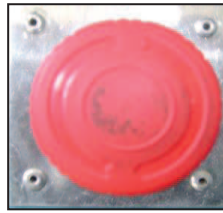
Foto 6.30: Paro de emergencia
