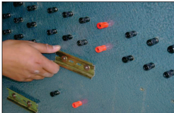
Foto 6.17: Rieles dim Fuente: Módulo de Control Industrial Elaborado por: Cbos. Guanín Roberto
