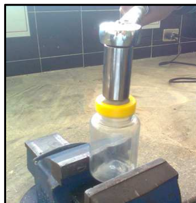
Fig. 3.37 Proceso experimental para determinar el torque.
