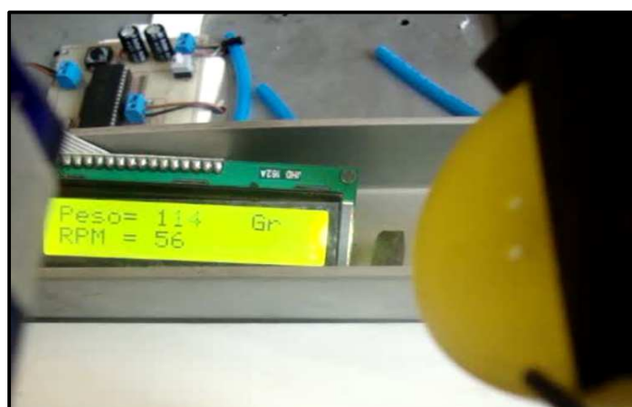
Fig. 6.10 Pruebas de funcionamiento dato inestable del peso.
