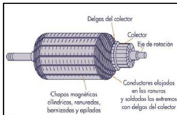
Fig. 2.3 Partes del rotor.
