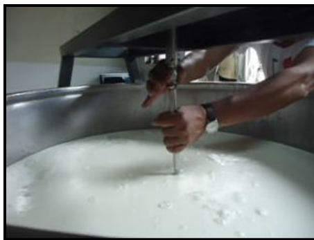
Foto 16. Paleta de agitación acoplada al motor Elaborado por: Santiago Villavicencio
