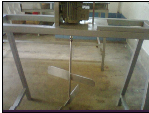
Foto 13. Motor con Agitador Elaborado por: Santiago Villavicencio
