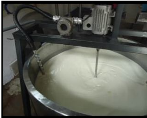
Foto 19. Sensor de temperatura en la materia prima Elaborado por: Santiago Villavicencio
