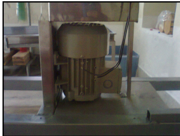
Foto 14. Montaje de motor Elaborado por: Santiago Villavicencio
