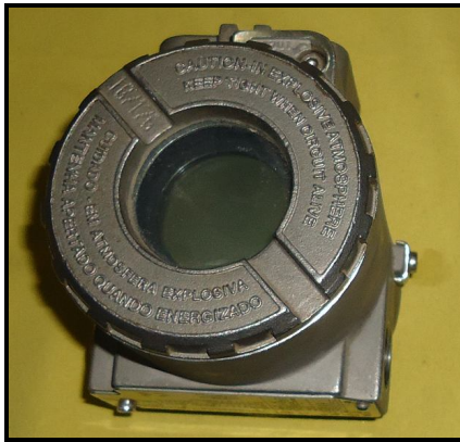
Foto 1. Transmisor de temperatura TT301
