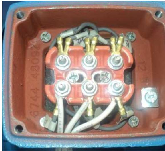
Foto 2. Motor trifásico físicamente conectado  $\Delta\Delta$ - 220V
