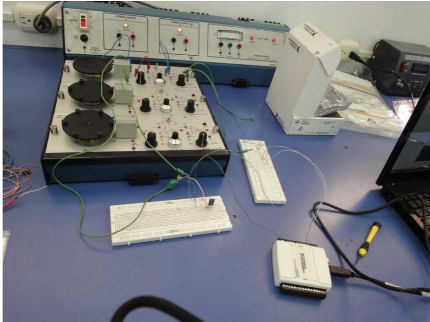
Foto. 5. Conexiones finales con la USB6009
