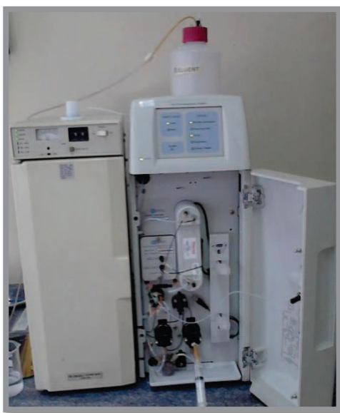
Fig. 13 Sistema supresor de conductividad continuo, DIONEX ASRS 300 de 4mm.
