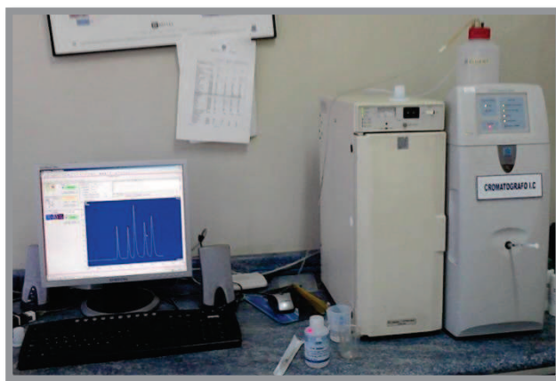
Fig. 11 Cromatógrafo de intercambio iónico con supresión química
