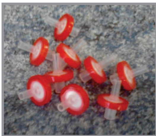
Fig. 26 Filtros de jeringa de 0,45 \mu\text{m} .
