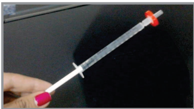
Fig. 27 Jeringa prelavada de 1 mL de capacidad con filtro, sin aguja.
