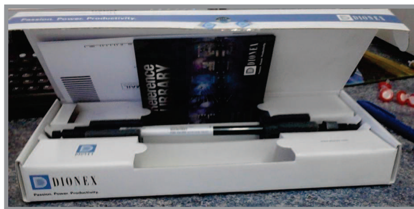
Fig. 12 Columna de intercambio iónico para aniones, DIONEX IonPack AS 14, de 4 x 250 mm. y Guarda columna de intercambio para aniones, DIONEX IonPack AG de 4 x 50 mm.
