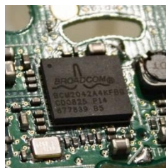
Figura 2.12 El Chip Broadcom BCM2042, la base de construcción de un Wiimote
