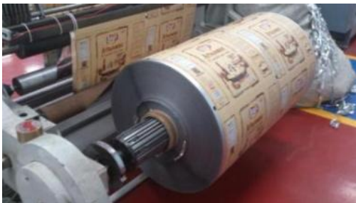
Figura 16. Bobina madre cargada en el desbobinador lista para ser cortada
