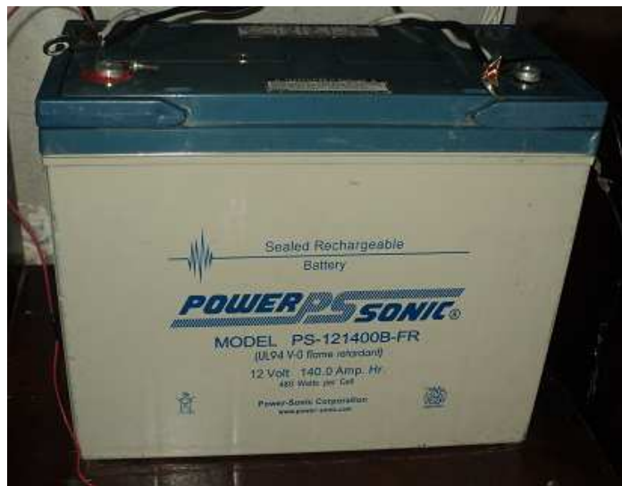
Foto 3.3 Nueva Batería de ciclo profundo Power sonic.
