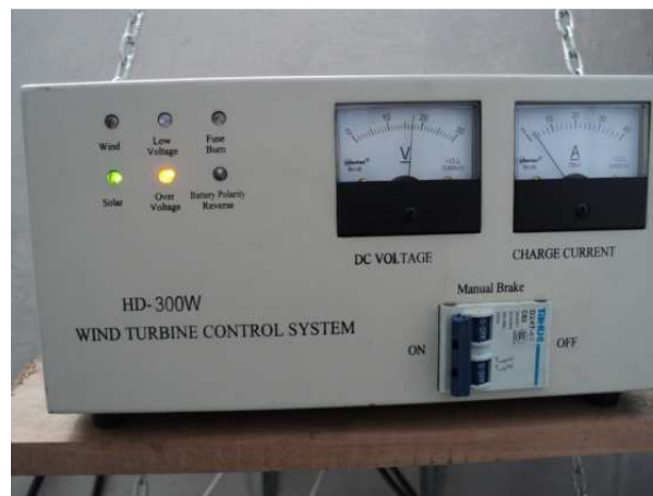
Foto 2.1 Controlador de carga tipo INDOOR.
