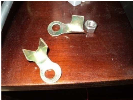
Foto 3.6 Terminales para batería.
