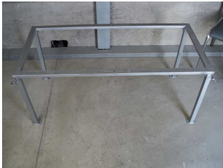
Foto 3.7 Soporte para el panel solar.
