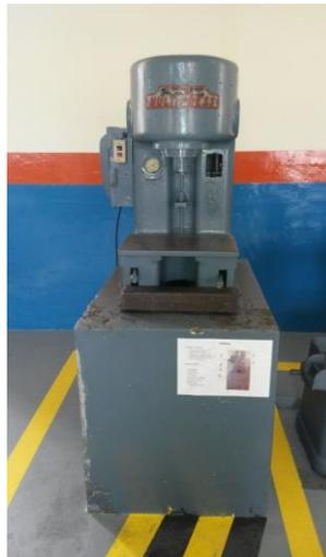
**Fotografía 42: Prensa hidráulica.**
