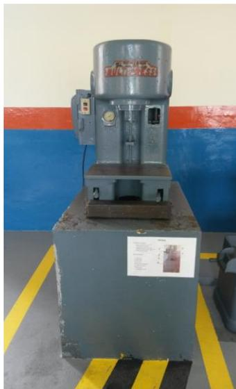
**Fotografía 29: Prensa Hidráulica.**
