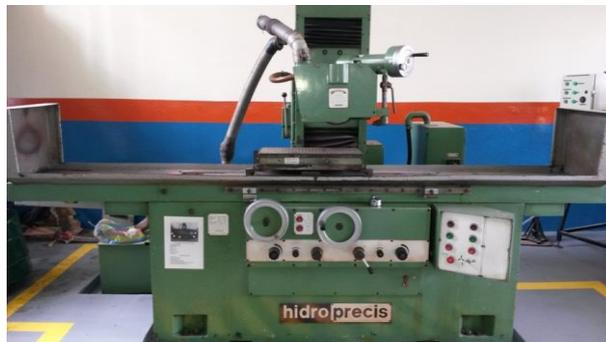
**Fotografía 63: Rectificadora plana Hidroprecis.**
