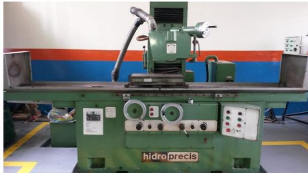
**Fotografía 1: Rectificadora plana Hidroprecis.**
