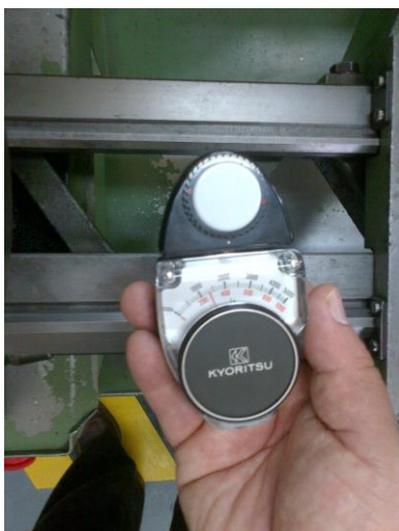
**Fotografía 80: Medición de 340 Lux (iluminado).**
