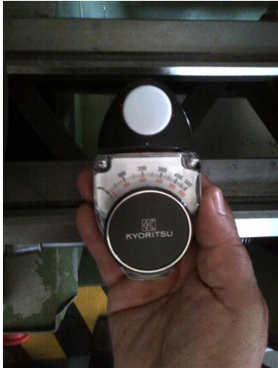
**Fotografía 78: Medición de 50 Lux (sin iluminación).**
