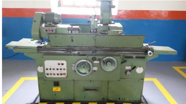
**Fotografía 4: Rectificadora cilíndrica Misal.**
