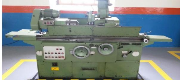
Fotografía 26: Rectificadora cilíndrica Misal RML 600.
