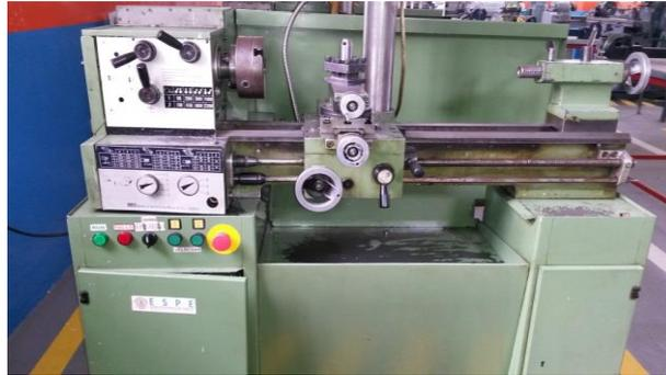
**Fotografía 34: Torno Emco – Maximat Super 11.**
