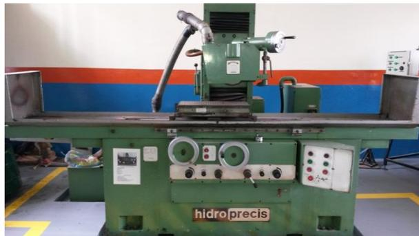
**Fotografía 40: Rectificadora plana Hidroprecis.**
