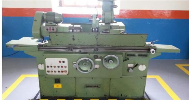
**Fotografía 66: Rectificadora cilíndrica Misal RML 600.**
