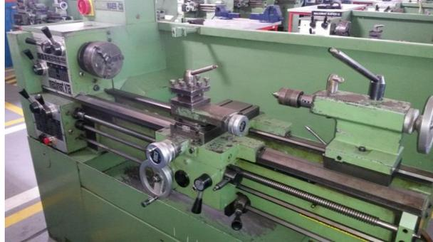
Fotografía 24: Torno Emco – Maximat V13.
