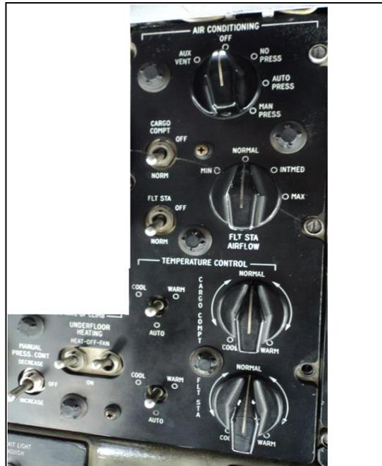
Fig. 2.18. Tableros de control de Aire Acondicionado
