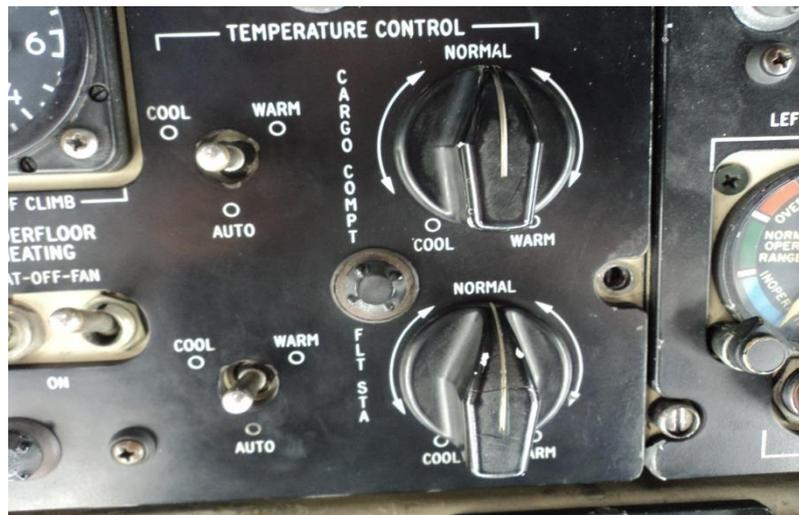
Fig. 2.19. Controles del aire acondicionado
