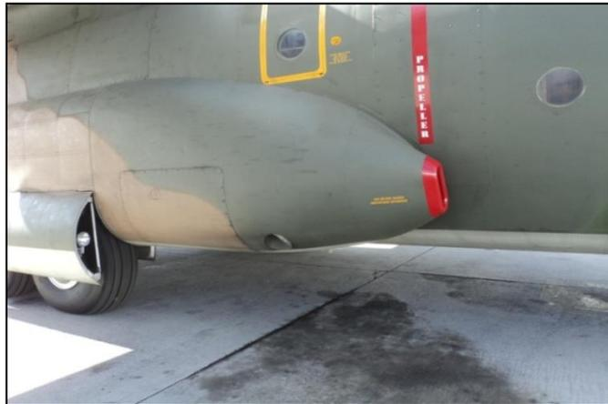
Fig. 2.13. Toma de aire de impacto para el compartimiento de carga
