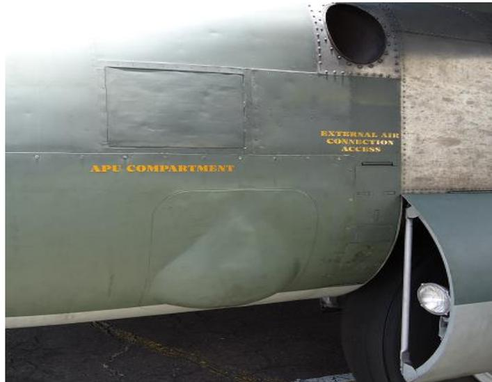
Fig. 2.5. Unidad de energía auxiliar (APU)
