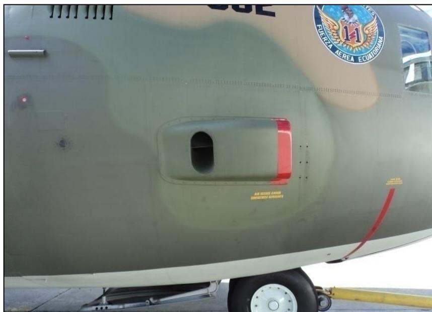
Fig 2.17. Toma de aire de impacto para la cabina
