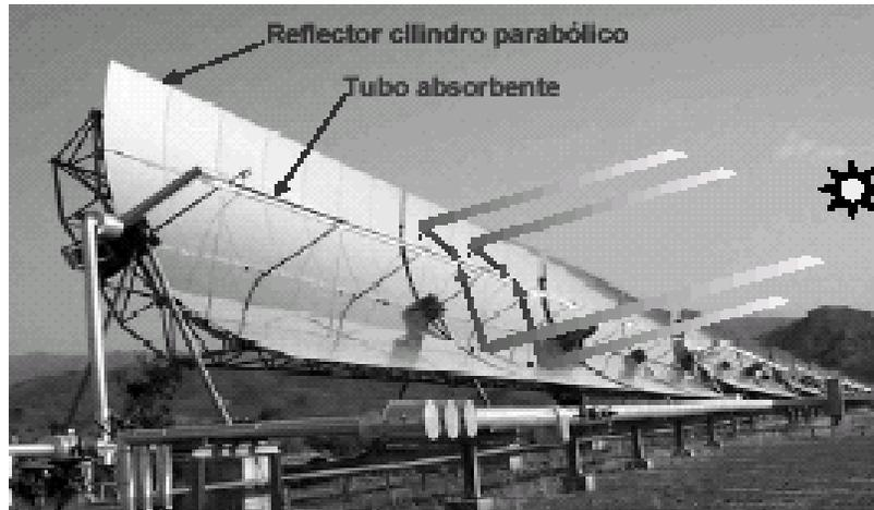
**Figura 2.14 Concentrador cilíndrico parabólico típico**
