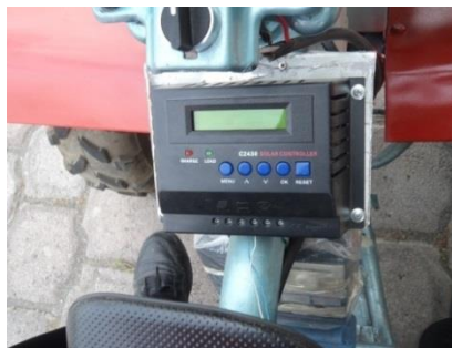
Figura 4.16 Regulador del panel solar Fuente: Grupo de investigación.
