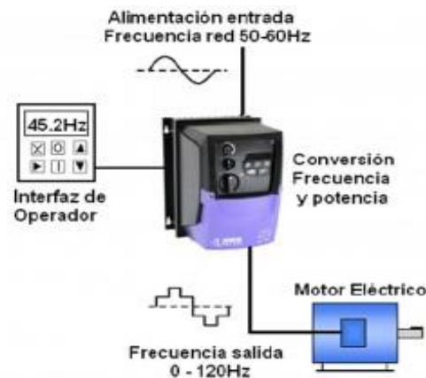
Figura 2.15 Circuito de control de velocidad Fuente: http://www.elblogdelinstalador.com
