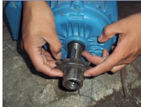
Figura 4.6 Instalación del acople.
