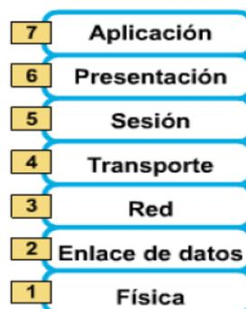
Figura 2.23: Capas del modelo OSI.
