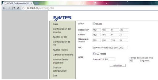
Figura 20: Configuración de Dispositivo Mediante Interfaz WEB
