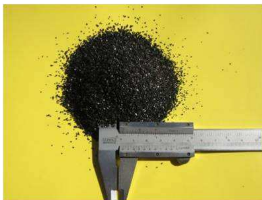
Figura 2. 5 - Ilustración tamaños de la granalla mineral
