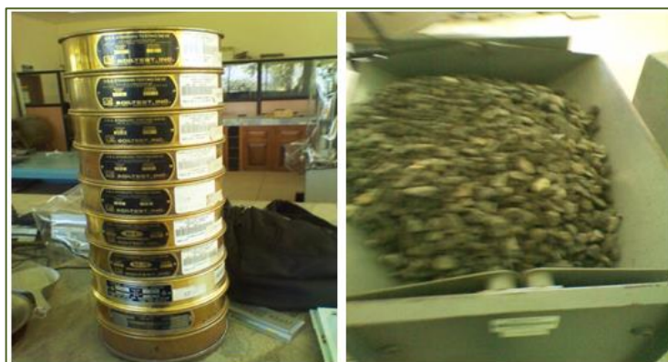
Figura: 4.2.1 Tamizado y cuarteado de material
