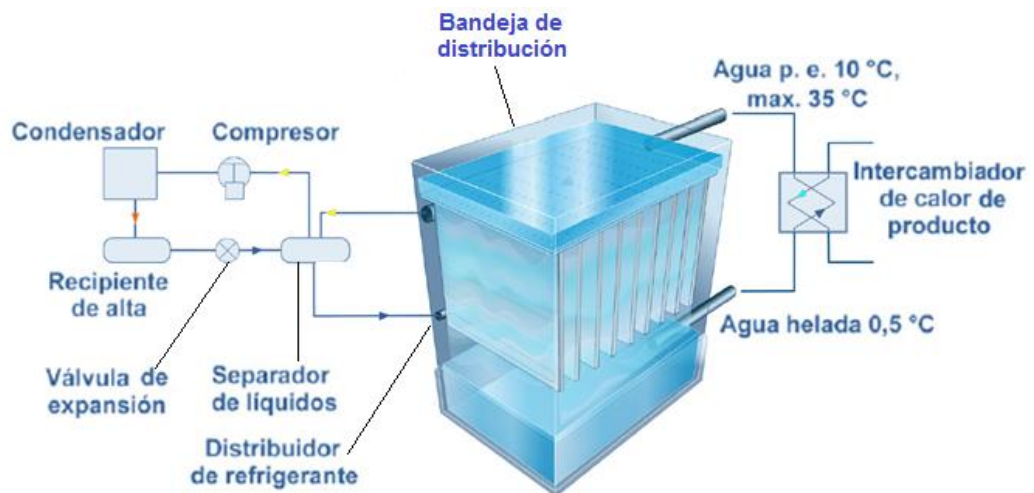
Figura 2. 2. Esquemático de un equipo de enfriamiento de película descendente
