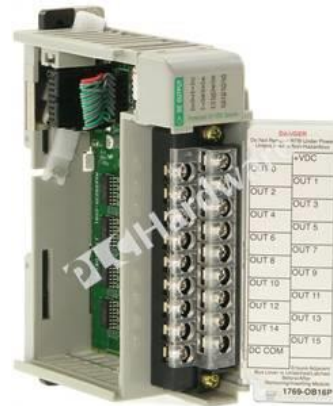
Figura 4. 6. Módulo de salidas DC 1769-OB16P
