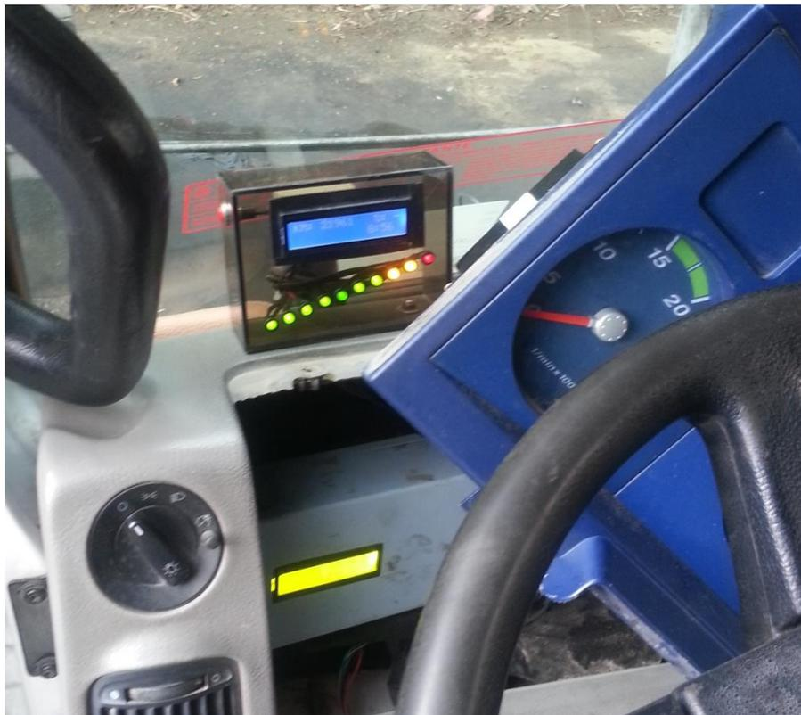
**Gráfico No. 116: Pruebas de Horómetro y Recorrido**
