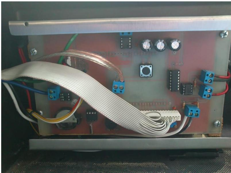
**Gráfico No. 110: Módulo Arduino y Acopladores**
