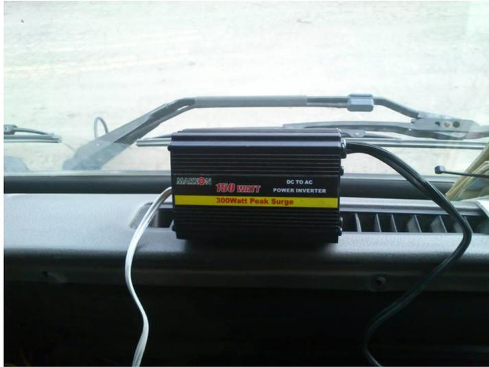
**Gráfico No. 107: Convertidor de Voltaje.**
