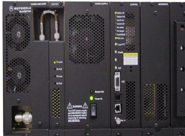
**Figura 1.14: Repetidor Quantar**
