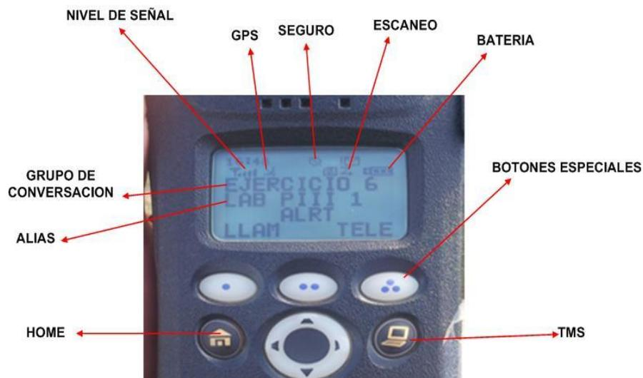
**Figura 3.22: Partes de la pantalla de radio XTS 2250 modelo III.**
