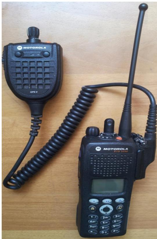
**Figura 2.20: Radio Digital XTS 2250 MOD III con GPS**
