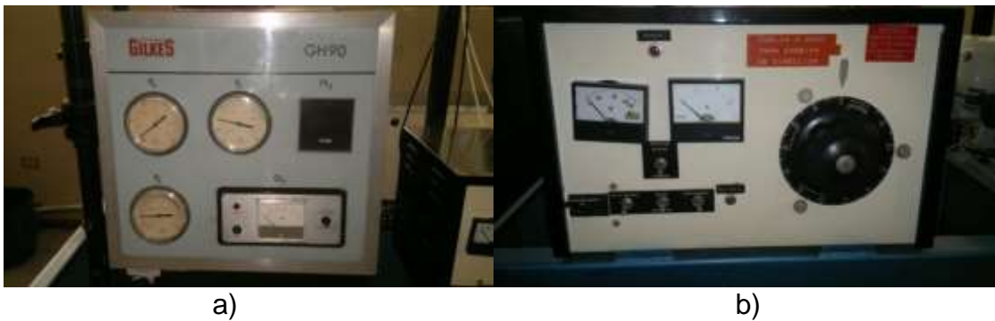
FIGURA 3.3 a) Panel de medidores de presión, r.p.m., caudal. b) Panel de instrumentos.
