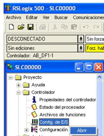
**Figura 3. 7** Configuración del módulo de expansión.
