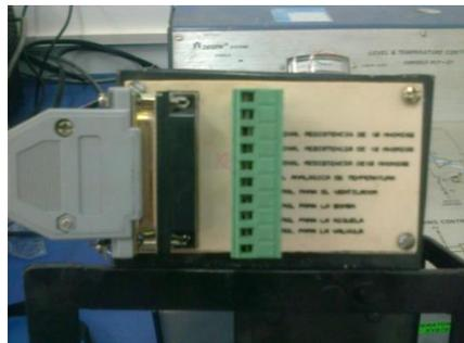
**Fotografía 3. 3** Placa de conexión de la estación de nivel.
