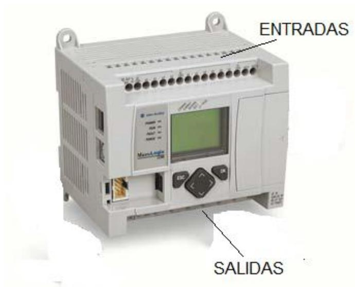
**Figura 2. 8** PLC (Controlador Lógico Programable).
