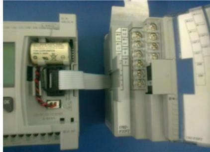
**Fotografía 3. 2** Conexión del PLC con módulo de expansión.
