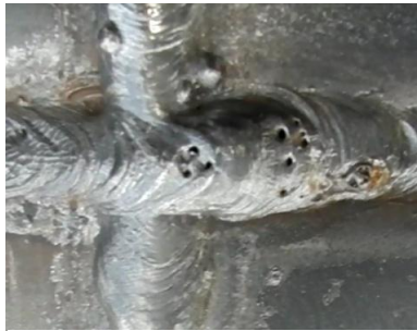
Norte SMAW Viga principal (Alta densidad de poros)
