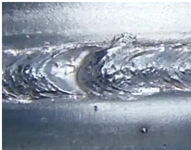
Norte GMAW Viga principal (cráter)
