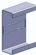
Fig. 30 Ubicación de probetas para ensayos de tracción en el alma.
