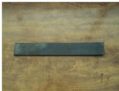
Figura 3.14 Probetas de platina metálica de 30mm x 6mm
