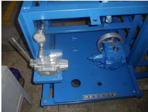
Figura 4.51 Colocación de la válvula direccional
