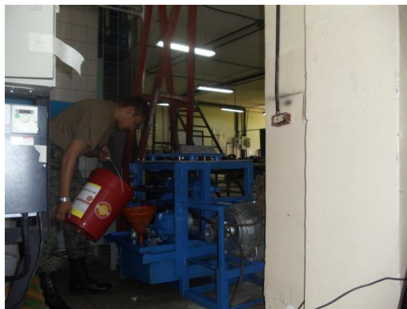
Figura 4.33 Reemplazo del aceite hidráulico
