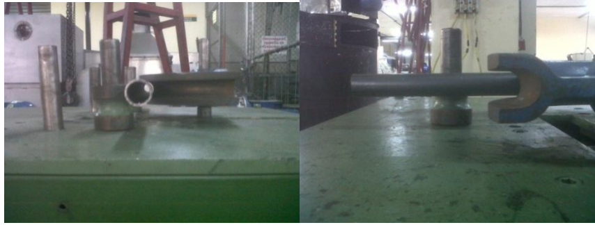
Figura 3.33 Desalineación entre la matriz y los rodillos
