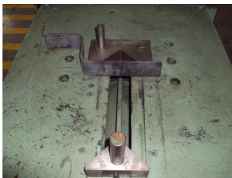
Figura 3.25 Segundo doblado efectuado con la pletina metálica
