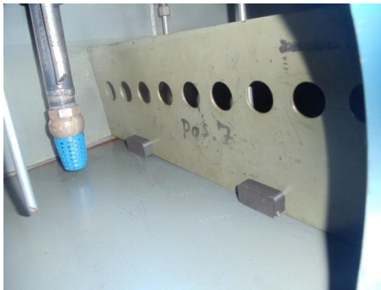
Figura 4.30 Válvula anti retorno colocada en la succión
