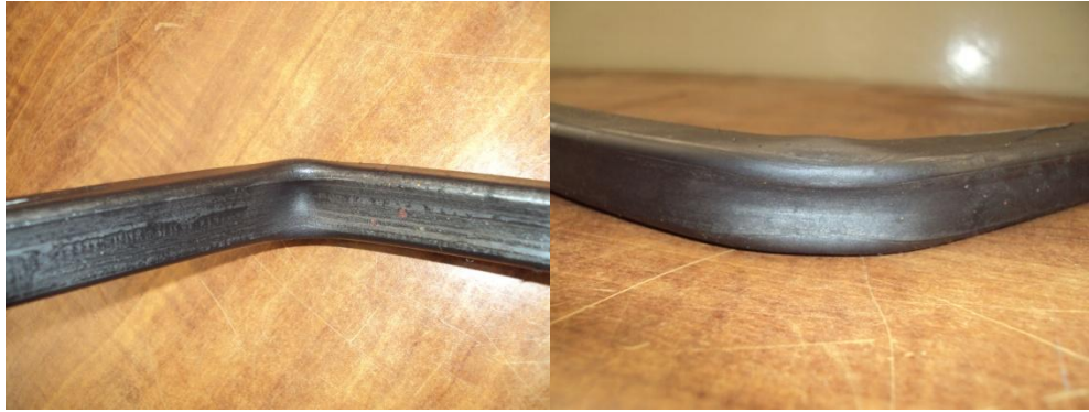
Figura 3.17 Achatamiento interno en el tubo cuadrado
