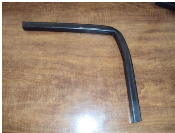
Figura 3.18 El tubo no sigue el contorno de la matriz
