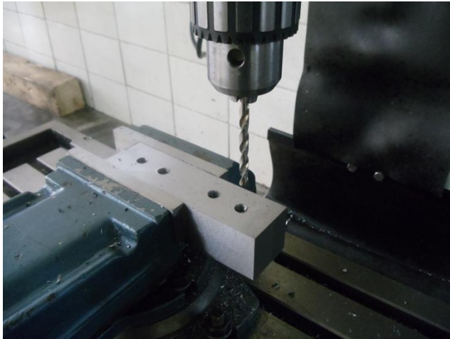
Figura 4.40 Construcción de topes para las zapatas posteriores
