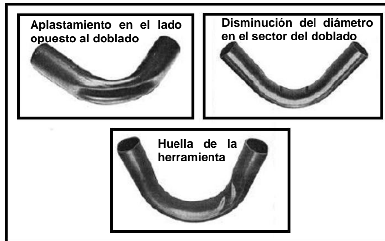
Figura 2.14 Principales problemas presentes en el doblado de un tubo
