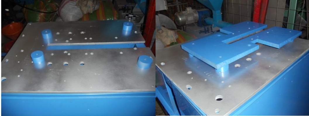
Figura 4.56 Ubicación de topes y base de apoyo
