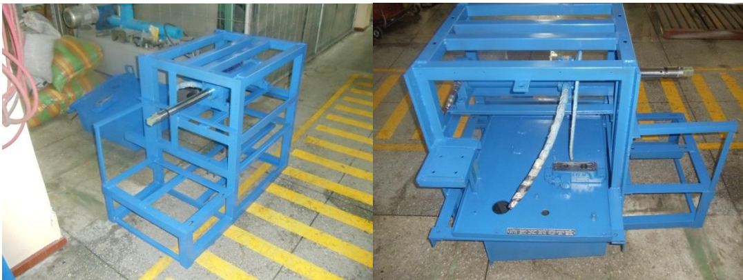
Figura 4.49 Colocación del reservorio de aceite
