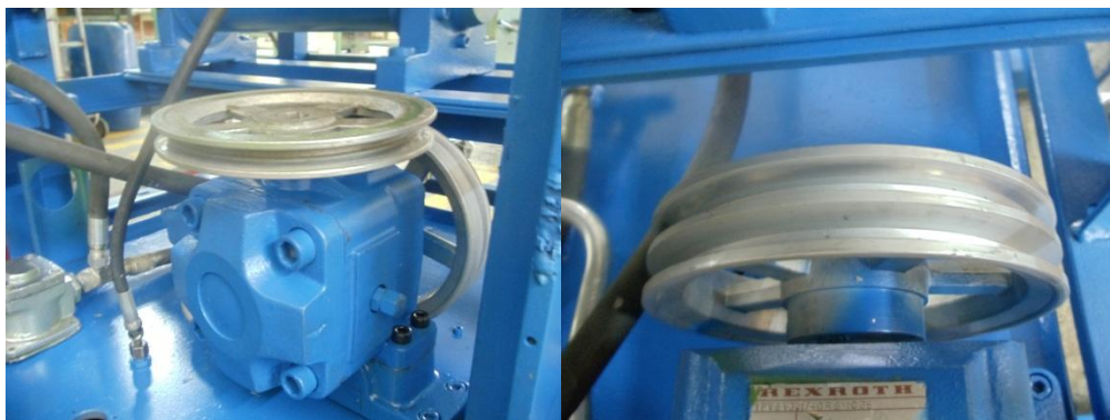
Figura 4.31 Cambio de la polea simple por una de doble canal
