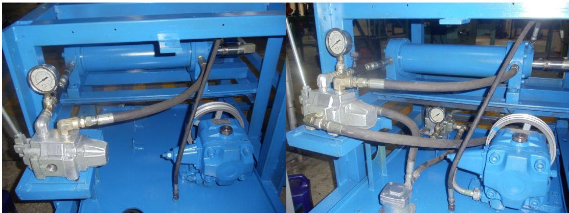
Figura 4.52 Conexión de la tubería
