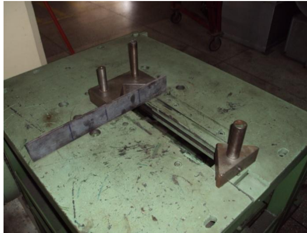
Figura 3.15 Pletina metálica lista para ser doblada
