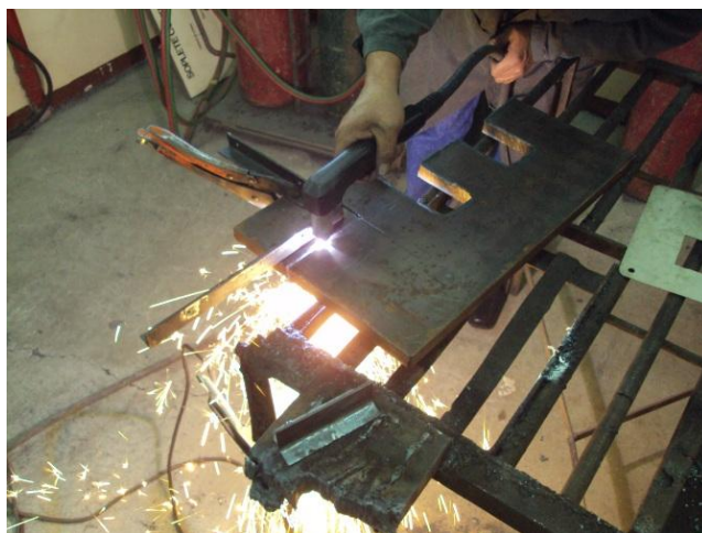
Figura 4.38 Corte de los brazos giratorios mediante plasma
