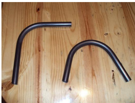
Figura 3.20 Tubo redondo de 1 pulgada doblado a 90° y 180°
