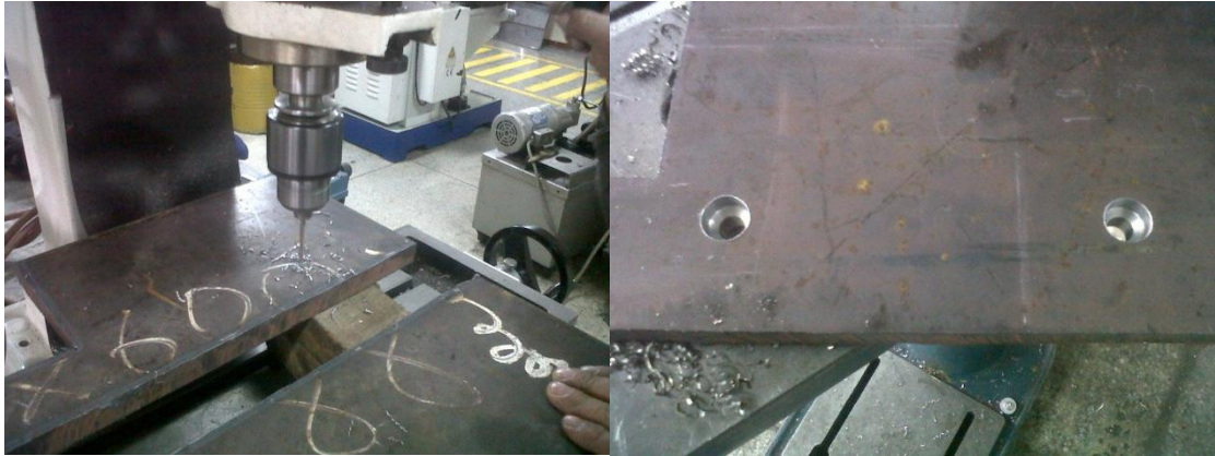
Figura 4.36 Perforado de agujeros en la base de apoyo
