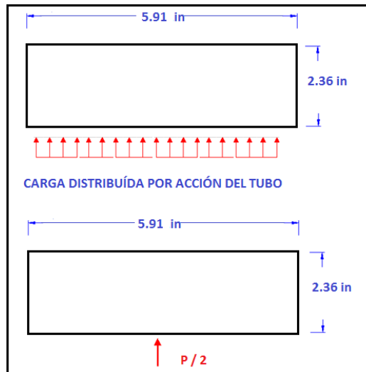
Figura 4.17 DCL del tope de apoyo
