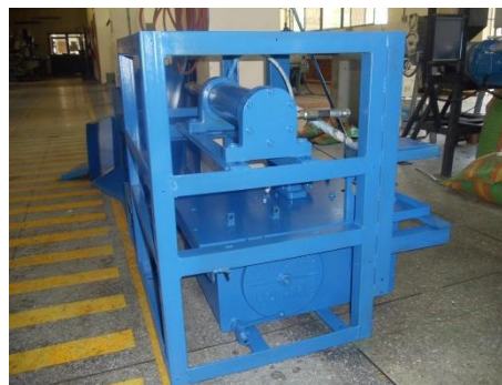
Figura 5.2 Cilindro hidráulico luego del mantenimiento
