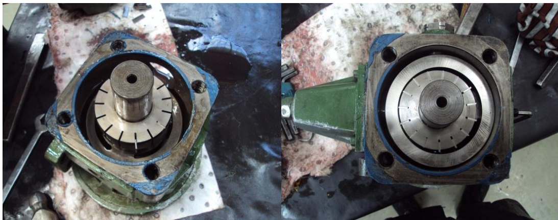
Figura 3.36 Vista de los componentes internos de la bomba hidráulica
