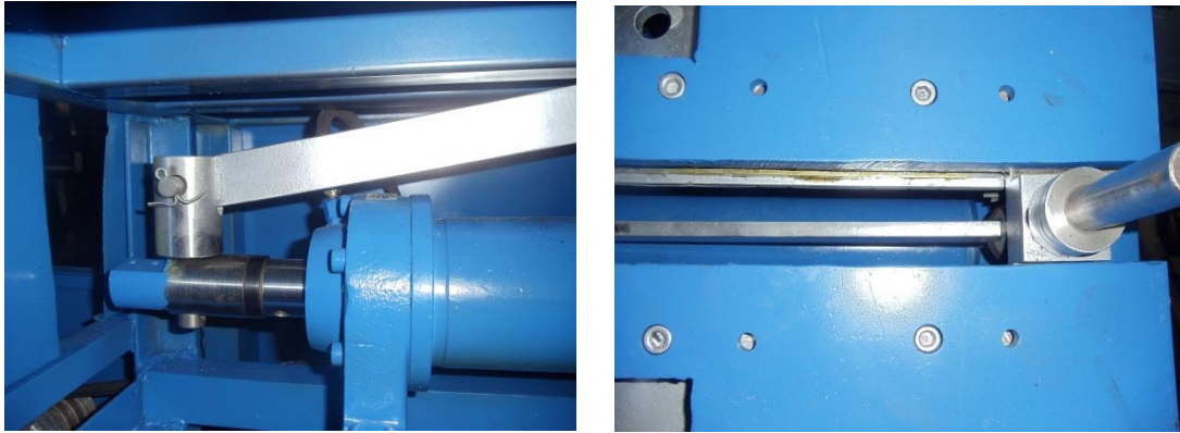
Figura 4.58 Barra de acoplamiento y elemento porta matrices
