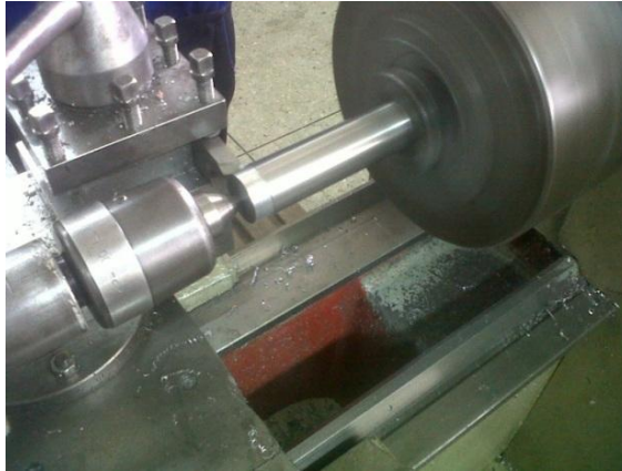
Figura 4.42 Torneado de pasadores para los brazos giratorios
