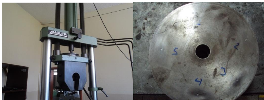
Figura 3.46 Ensayo de dureza realizado en las matrices
