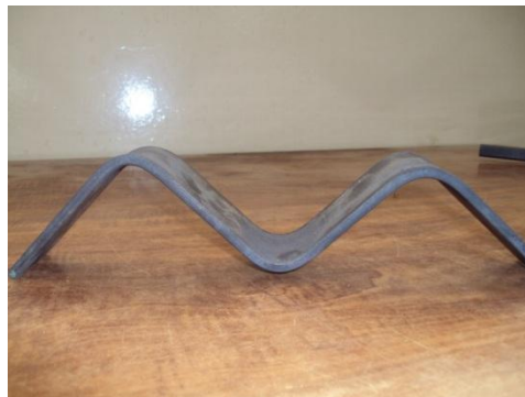
Figura 3.26 Resultado final de la prueba de doblado con pletina metálica
