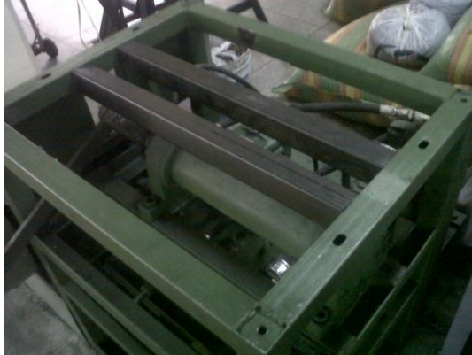
Figura 4.34 Colocación de dos tubos adicionales en la estructura
