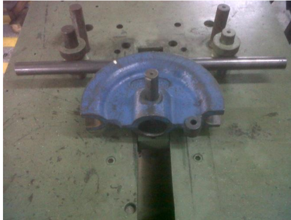
Figura 3.8 Tubo de 1 pulgada durante el proceso de doblado
