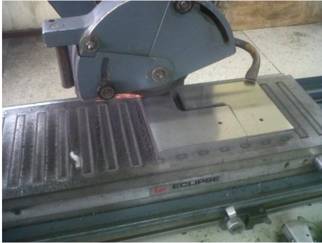
Figura 4.39 Rectificado superficial de los brazos giratorios
