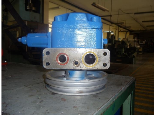
Figura 4.29 Reemplazo de empaques de la bomba
