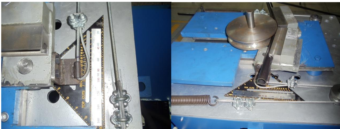
Figura 4.47 Sistema de control de ángulos de doblado
