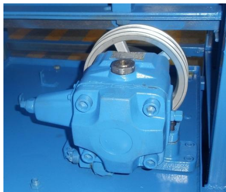
Figura 5.1 Bomba hidráulica luego del mantenimiento
