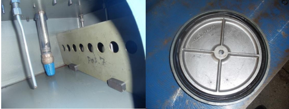
Figura 5.3 Vista interior del colector de aceite y del empaque de la tapa
