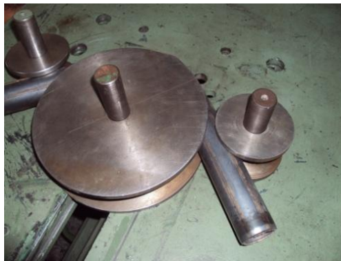
Figura 3.12 Probeta durante el proceso de doblado
