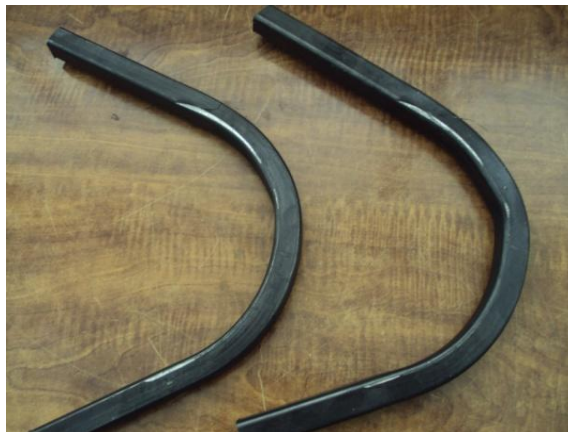
Figura 3.19 Marcas de la matriz en los costados internos del tubo
