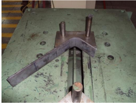
Figura 3.24 Primer doblado efectuado en la pletina metálica
