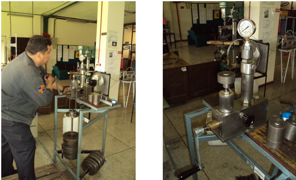
Figura 3.43 Comprobación de los manómetros
