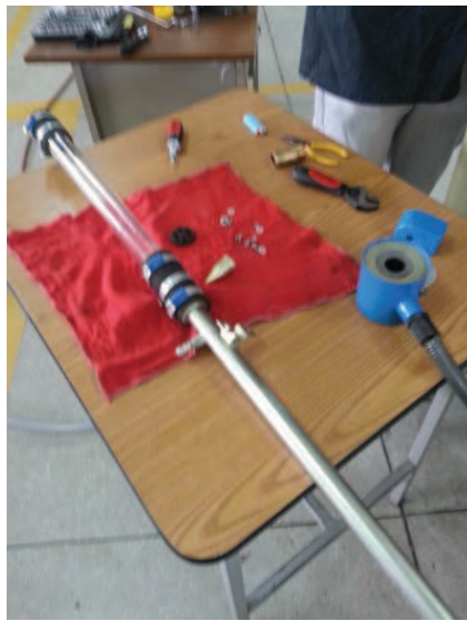
Figura 17 Desmontaje medidor de caudal
