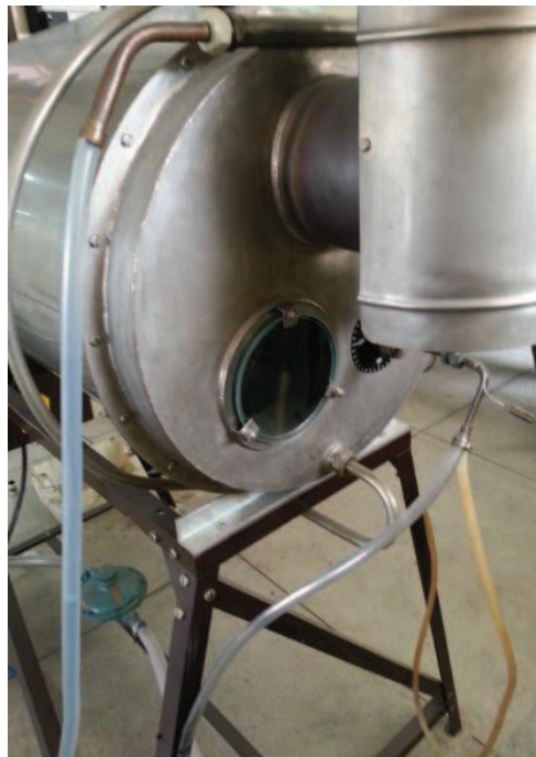
Figura 11 Sistema de refrigeración unidad de combustión
