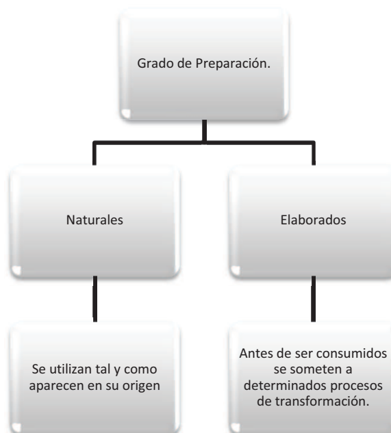
Figura 3 Clasificación de combustibles por grado de preparación
