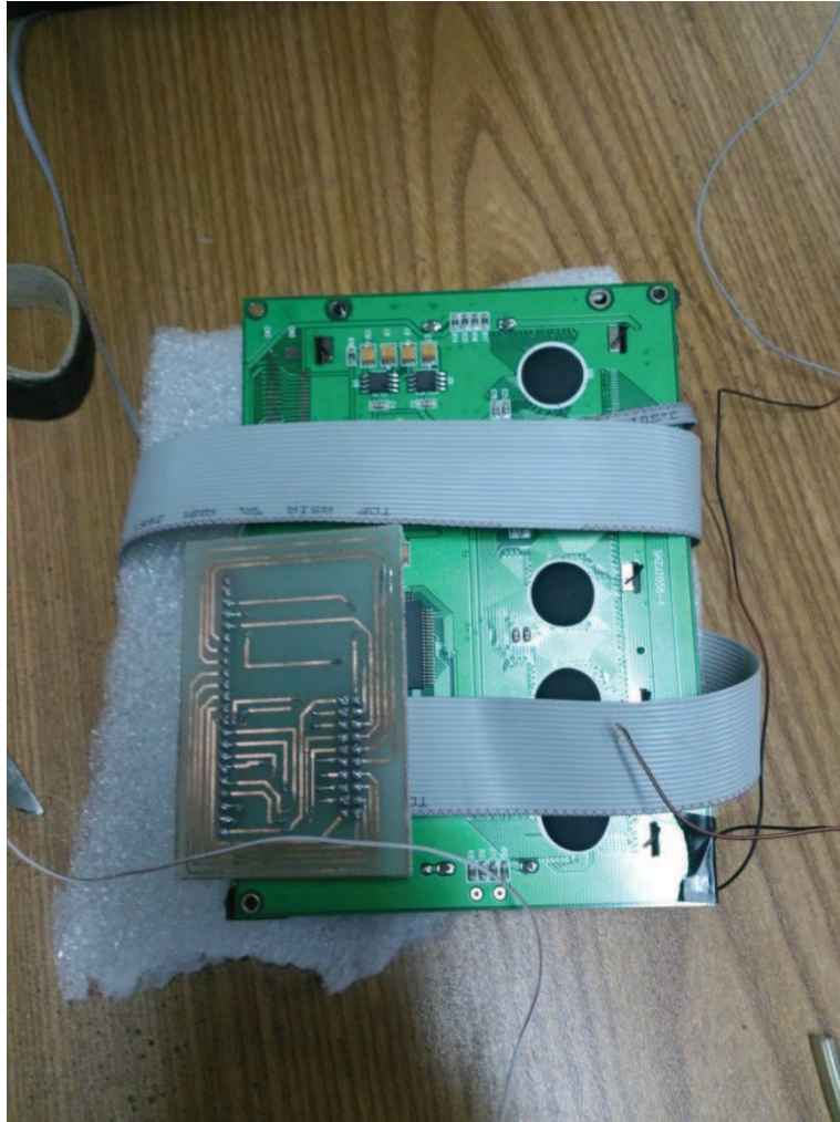
Figura 41 Conexión tarjeta electrónica con pantalla LED
