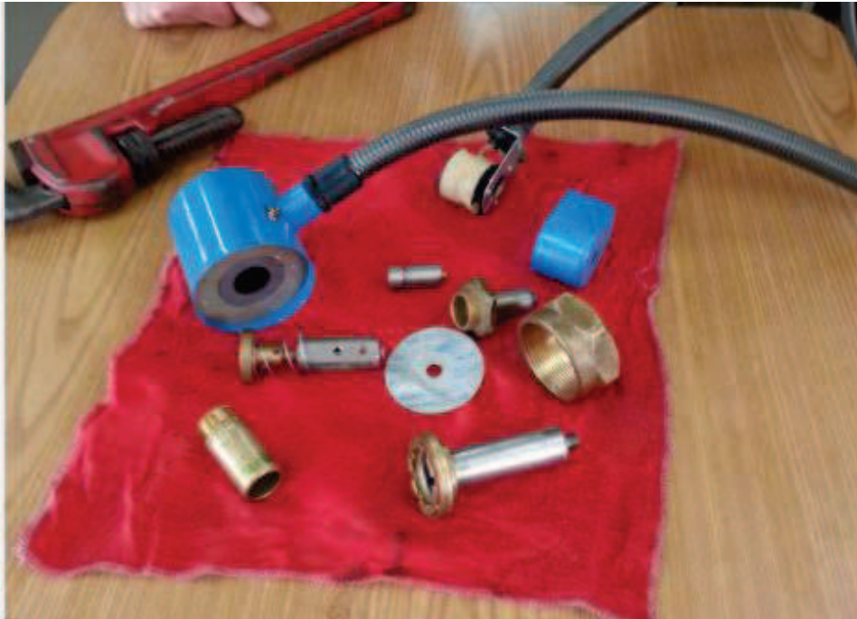
Figura 53 Mantenimiento de válvulas solenoides
