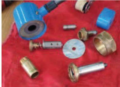
Figura 18 Desmontaje válvulas solenoides
