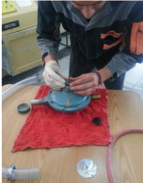
Figura 16 Mantenimiento línea de alimentación de combustible
