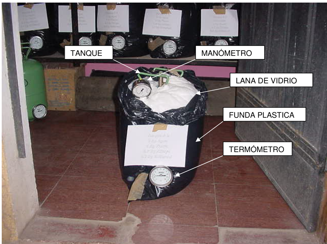
Figura 6.1. Partes de un tanque de prueba.
