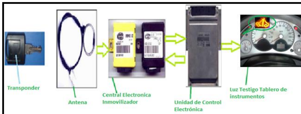
Fuente: Grupo de investigación Figura 2.7: Principio de funcionamiento
