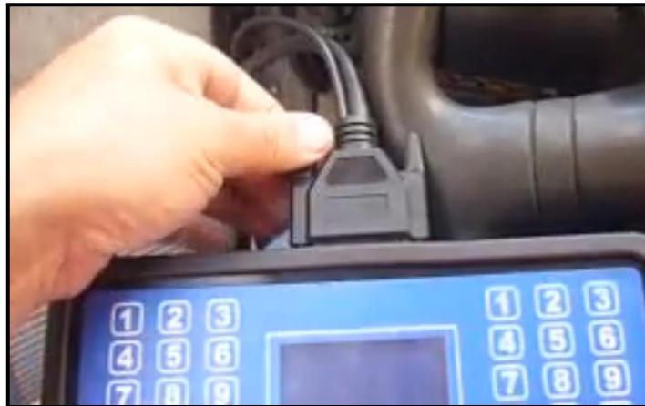
Fuente: Grupo de investigación Figura 5.29. Verificación de la conexión
