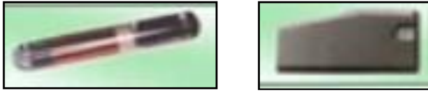
Fuente: Grupo de Investigación Figura 2.16 Chip en cristal, y cerámica
