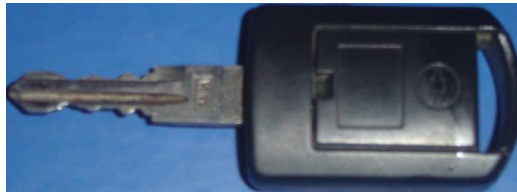
Figura 2.8: Llave con transponder en su interior.
