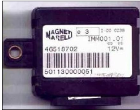
Fuente: Grupo de Investigación Figura 2.4: Unidad de mando (Módulo) del inmovilizador
