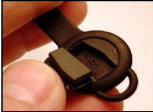
Fuente: Grupo de Investigación Figura 2.15 Transponder Rolling Code o Evolutivo
