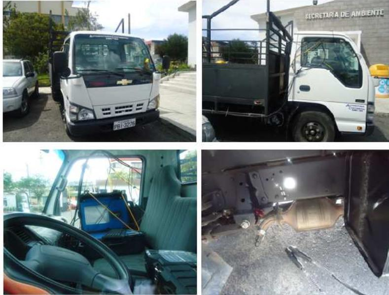
Figura 2. Vehículo pesado usado en pruebas con el analizador de gases
