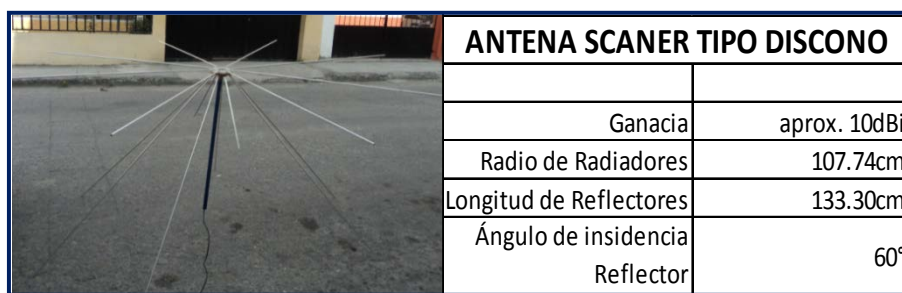
Figura 8: Antena Discono de Banda Ancha/Tabla 9: Parámetros constructivos Antena
