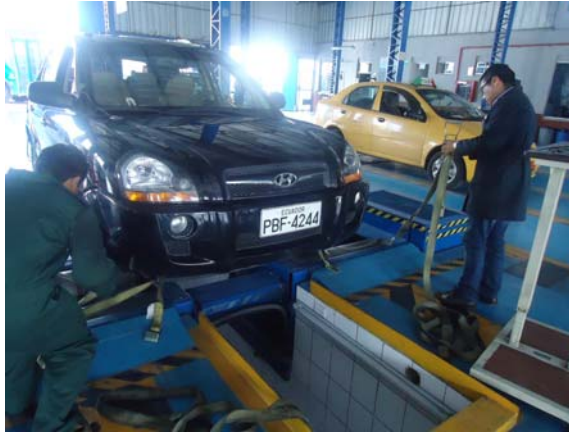
Figura 30. Asegurando vehículo al dinamómetro utilizado en las pruebas.
