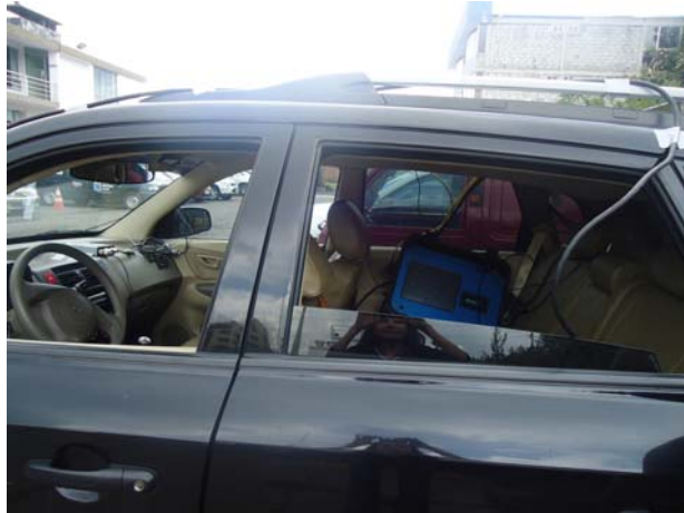
Figura 25. Instalación del analizador en gases en el vehículo liviano.
