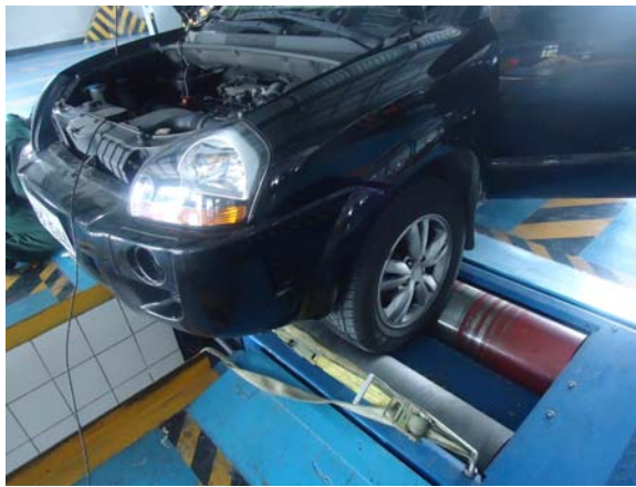
Figura 30. Asegurando vehículo al dinamómetro utilizado en las pruebas.
