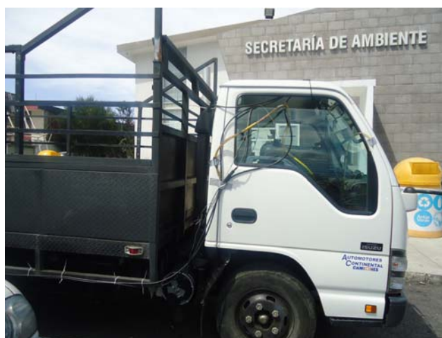
Figura 35. Instalación del analizador de gases en el vehículo pesado.
