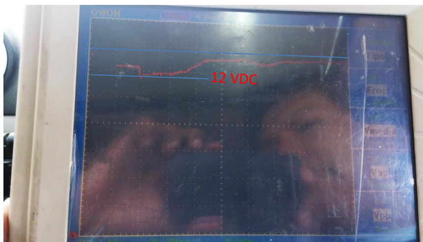
Figura No. 4.102: Voltaje en el encendido del Renault Stepway
