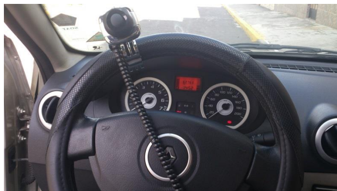
Figura No. 5.21: Instalación del cable de teléfono
