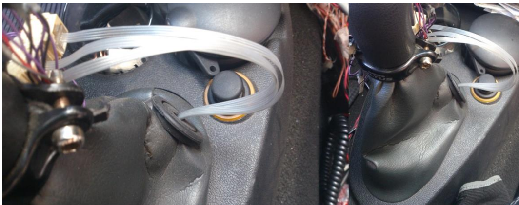
Figura No. 4.152: Acondicionamiento del guarda polvos
