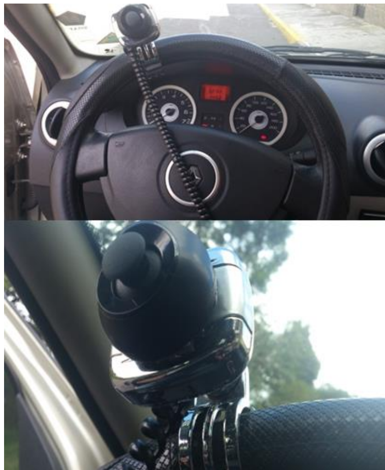
Figura No. 4.147: Instalación del joystick
