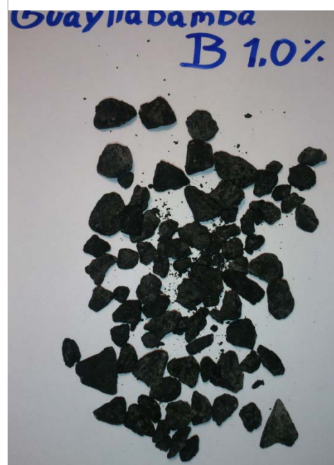
Figura 139: Peladura Guayllabamba 1.0% Aditivo B
