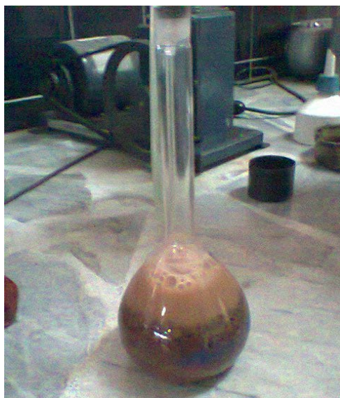
Figura 36: Picnómetro lleno para ensayo de peso específico con arena de Pintag
