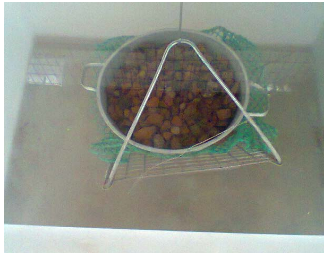
Figura 38: Agregado Grueso sumergido Para Peso Específico
