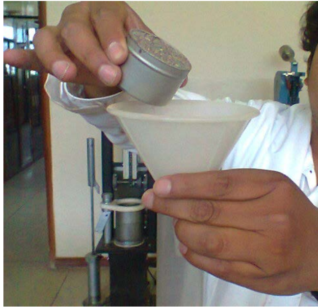
Figura 22: Proceso de vertido del Arena para el Equivalente de Arena
