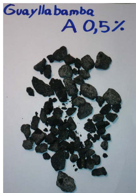
Figura 133: Peladura Guayllabamba 0.5% Aditivo A
