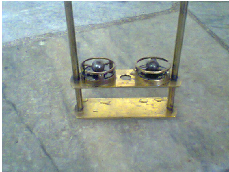
Figura 50: Equipo Armado para ensayo de Reblandecimiento
