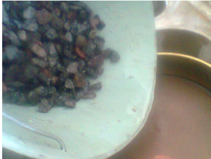
Figura 17: Agregado Grueso limpio
