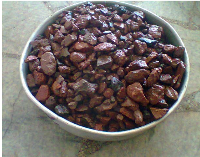
Figura 37: Agregado Grueso para ensayo de Peso Específico
