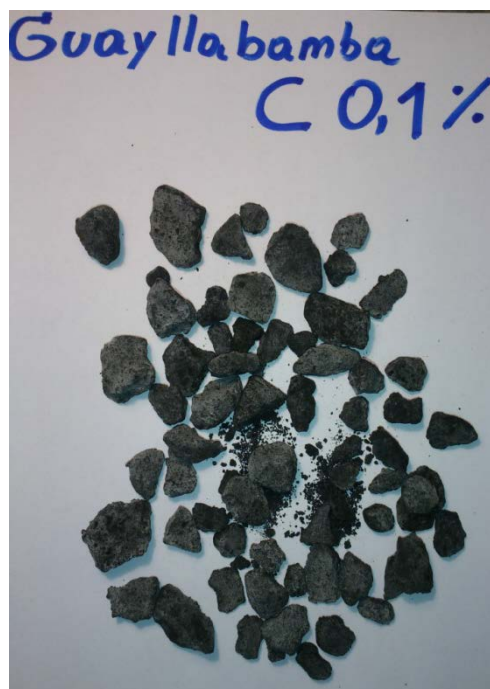
Figura 143: Peladura Guayllabamba 0.1% Aditivo C
