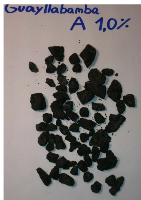
Figura 135: Peladura Guayllabamba 1.0% Aditivo A
