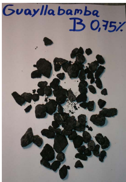
Figura 140: Peladura Guayllabamba 0.75% Aditivo B
