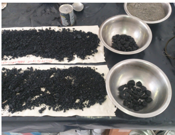
Figura 111: Muestras de mezcla listas para el Ensayo de Peladuras
