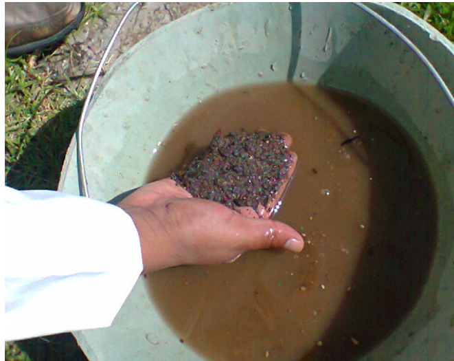
Figura 11: Proceso de lavado del Agregado
