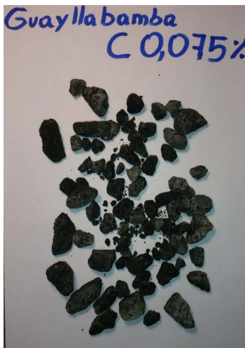
Figura 144: Peladura Guayllabamba 0.075% Aditivo C
