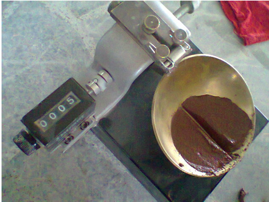
Figura 29: Ensayo en la copa de Casa Grande con material de Pintag
