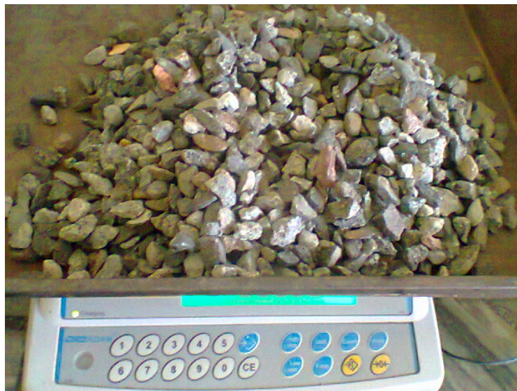
Figura 31: Agregado limpio para Ensayo de Abrasión
