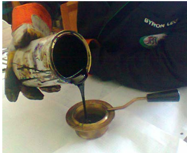
Figura 39: Asfalto vertido en la copa de Cleveland
