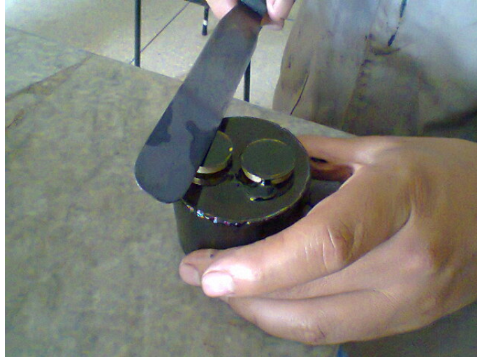
Figura 49: Anillos de Bronce para ensayo de Reblandecimiento
