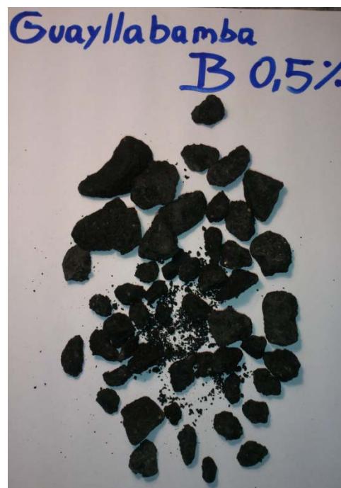
Figura 137: Peladura Guayllabamba 0.5% Aditivo B
