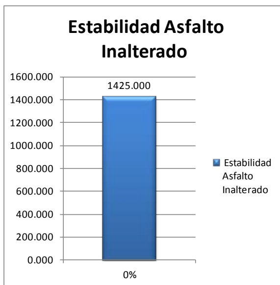
Figura 102: Estabilidad mezcla con Asfalto Virgen Guayllabamba
