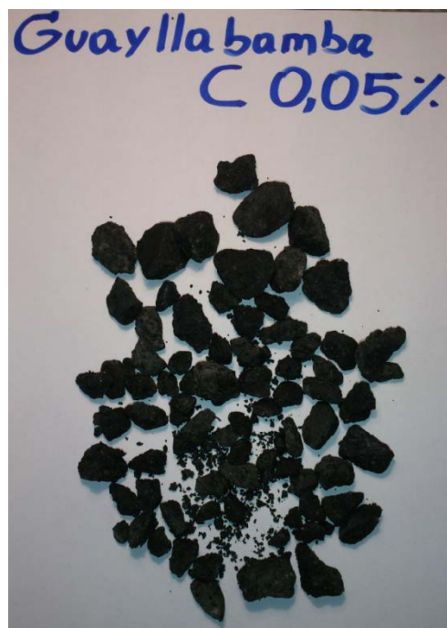
Figura 141: Peladura Guayllabamba 0.05% Aditivo C
