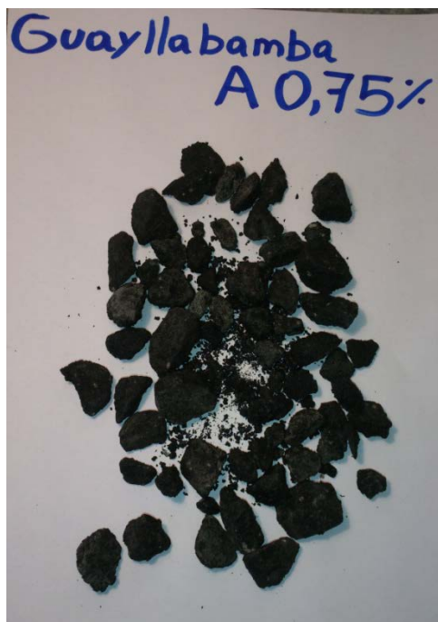
Figura 136: Peladura Guayllabamba 0.75% Aditivo A
