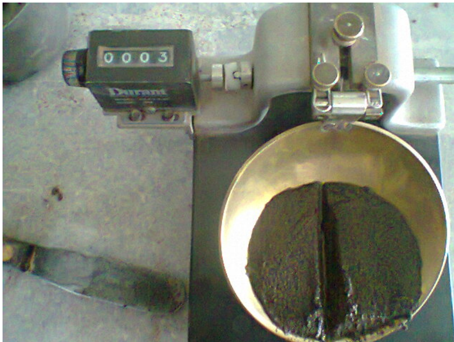
Figura 30: Ensayo en la copa de Casa Grande con material de Guayllabamba
