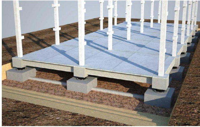
Figura 70 Losa de aislación (Mellado, 2012)
