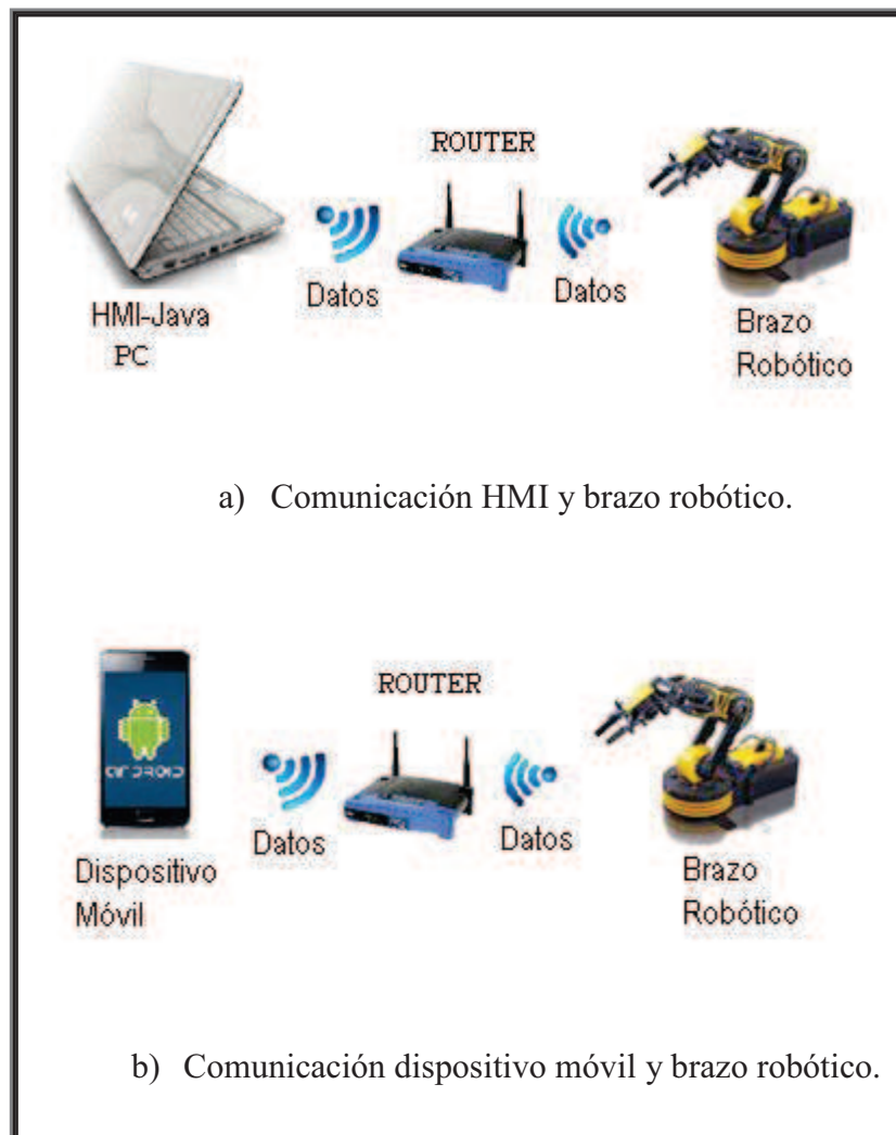
Figura 57. Comunicación inalámbrica en modo infraestructura
