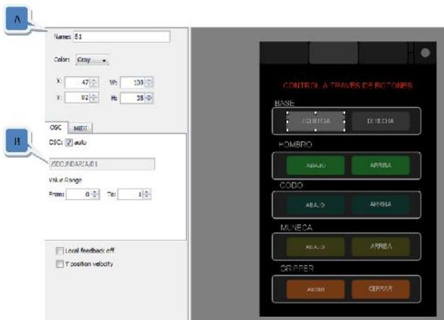
Fig. 6 Configuración Propiedades HMI Android
