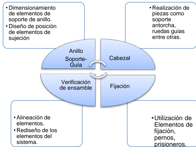
Figura 38. Matriz de construcción del cabezal.
