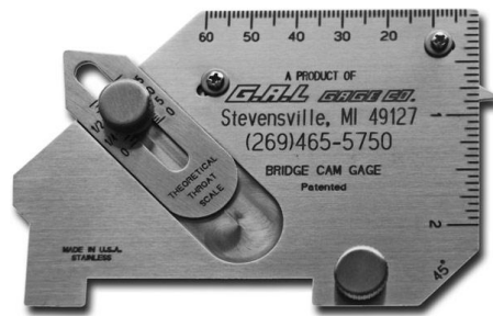
Figura 76. Galga para medir ángulos.
