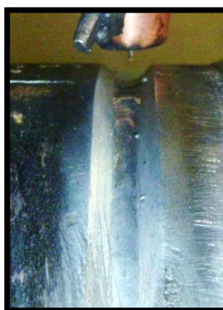
Figura 91. Junta soldada con respaldo izquierda-Prueba de Soldadura 6.b.
