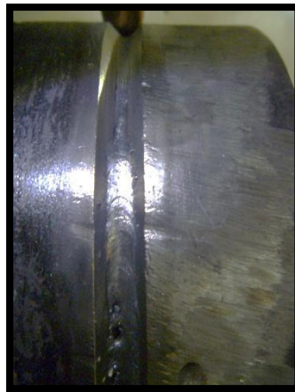
Figura 90. Junta soldada con respaldo derecha-Prueba de Soldadura 6.a.
