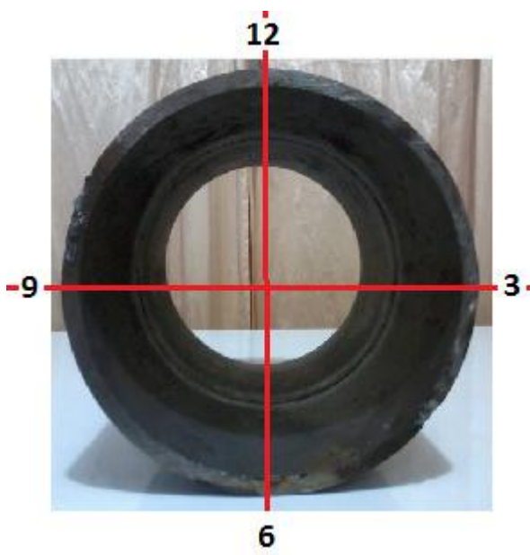
Figura 79. Asignación de la Tubería.
