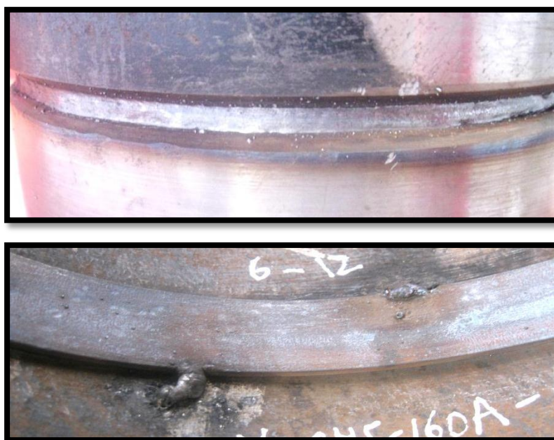
Figura 85. Junta soldada con respaldo izquierda-Prueba de Soldadura 3.b.
