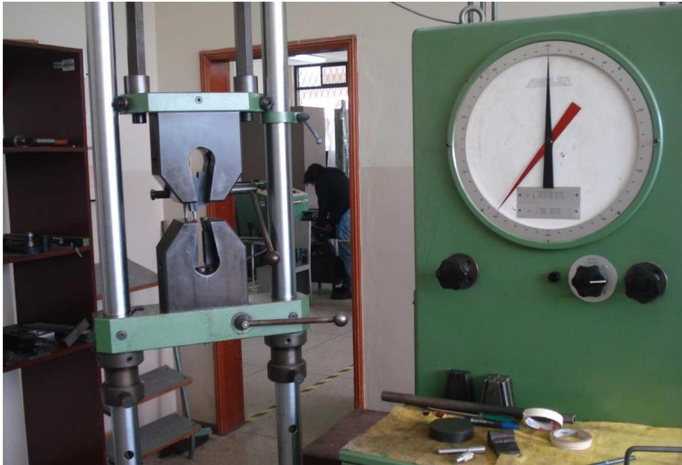
**Fig 3. 9 Máquina de Ensayos Universales**
