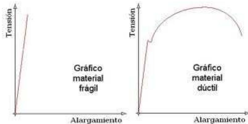
**Fig 2. 12 Diagrama esfuerzo-deformación para material dúctil y frágil**
