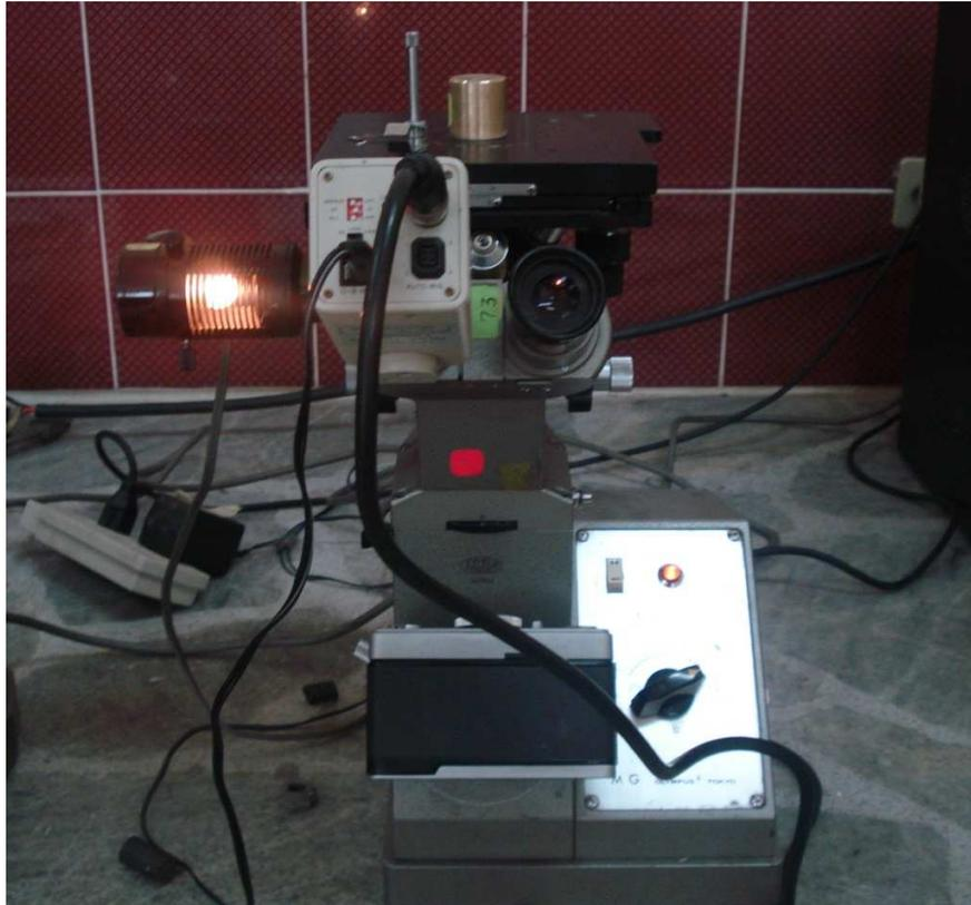
**Fig 3. 10 Microscopio Metalúrgico**
