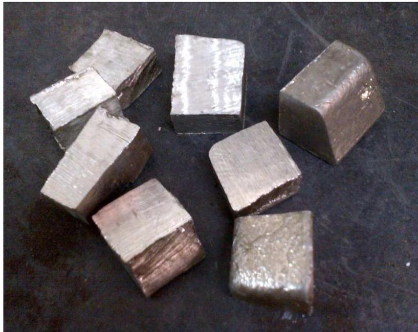
***Fig 3.3 Estaño Metálico***
