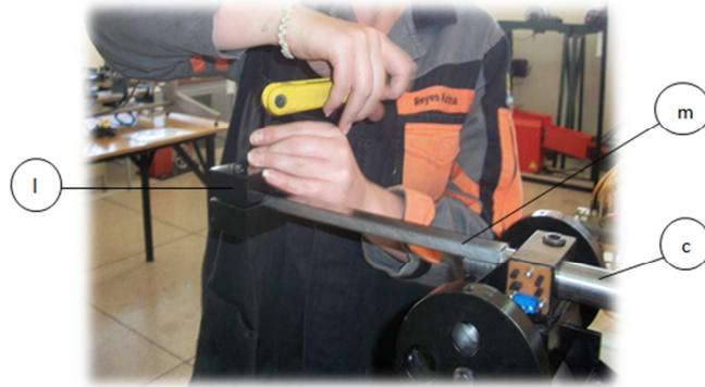
**Figura 3. Instalación del absorbedor de vibraciones**
