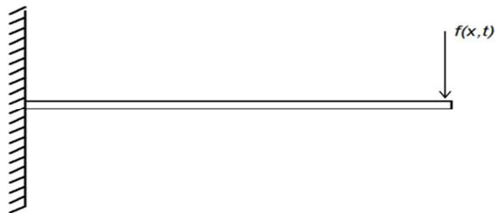
**Figura. 40** Viga en voladizo bajo vibración forzada
