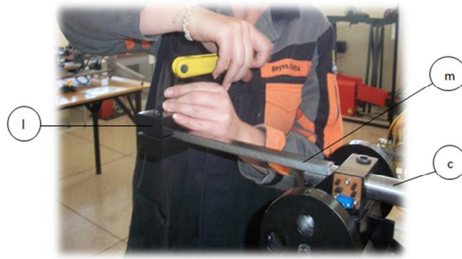
**Figura. 51 Instalación del absorbedor de vibraciones**
