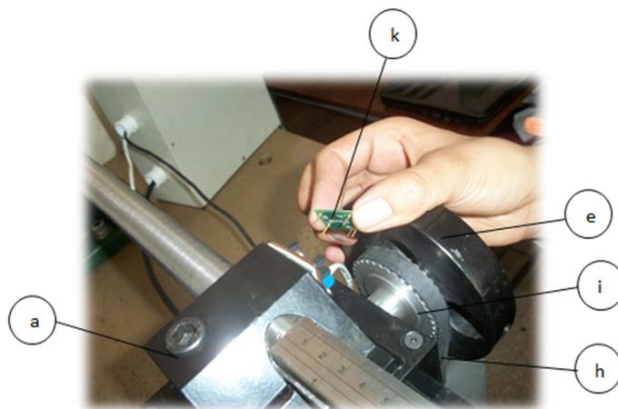
**Figura 4. Instalación del sensor sobre el acople de la viga**
