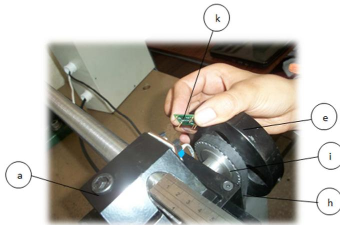
**Figura. 52 Instalación del sensor sobre el acople de la viga**
