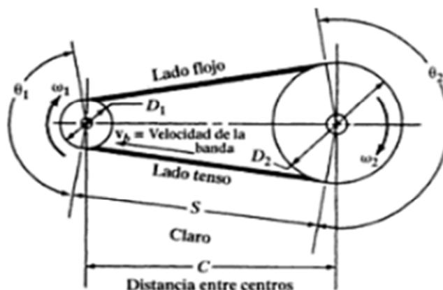
Figura. 29 Geometría básica de un impulsor de banda <sup>[32]</sup>
