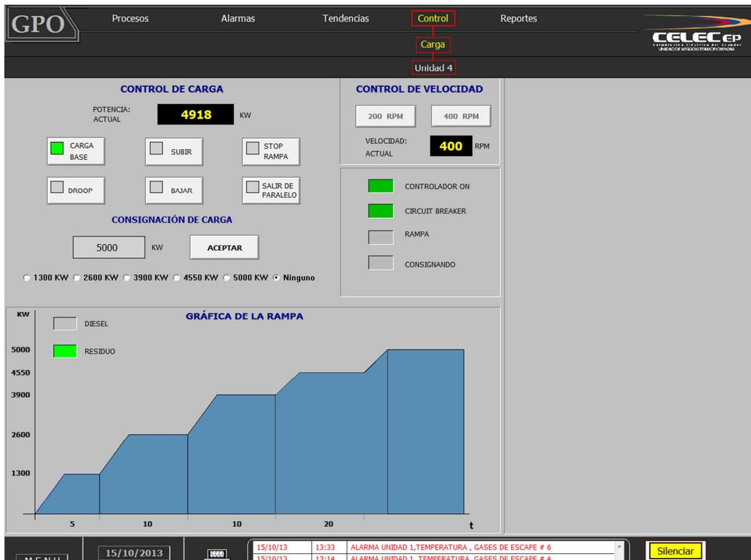
Figura 90. Interfaz Humano Máquina del Regulador de velocidad de la UG4
