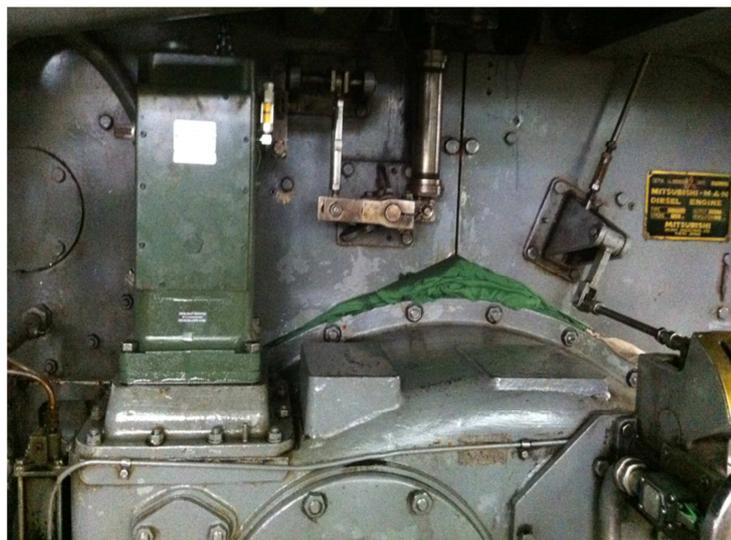
Fotografía 3. Actuador UG-Actuator para el control de velocidad de la UG4
