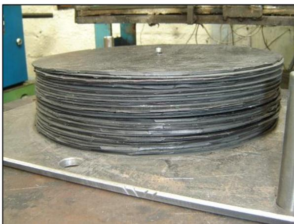
**Figura 111: Composición de la estructura interna del aislador.**
