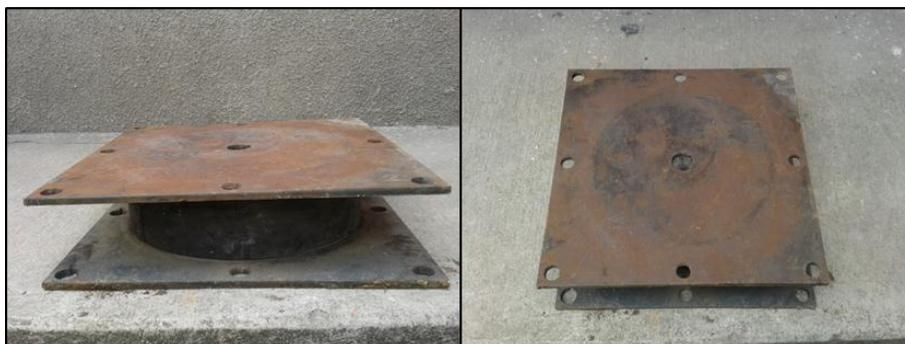
**Figura 101: Aislador elastomérico proporcionado por ANDEC antes de ser Ensayado**
