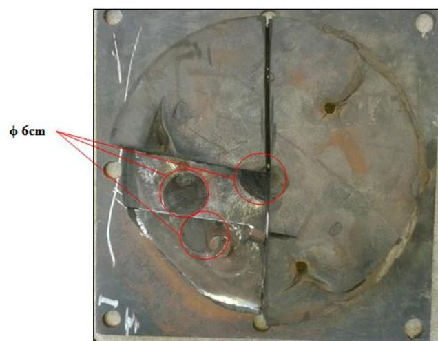
**Figura 107: Orificios en las placas de acero internas del Aislador.**
