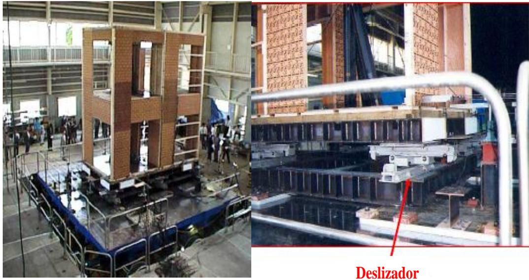
**Figura 10: Edificio con deslizadores.**
