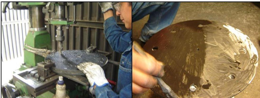
**Figura 115: Perforación de las láminas de refuerzo y colocación de una pega especial para el vulcanizado.**
