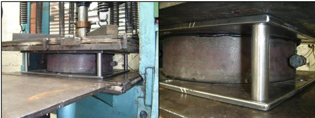
**Figura 119: Aislador colocado en la prensa de vulcanizado / excedentes de caucho producto del vulcanizado.**
