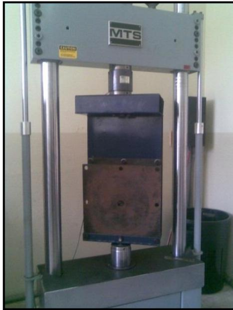
**Figura 102: Acople y Aislador elastomérico montados en la Máquina de Ensayos Universales**
