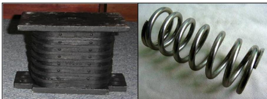
**Figura 98: Prototipo con resorte en el Núcleo. (Auqui M. , 2010)**
