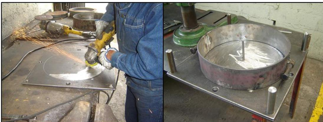
**Figura 116: Limpieza de las placas base y colocación de una pega especial para el vulcanizado en las bases y el molde.**
