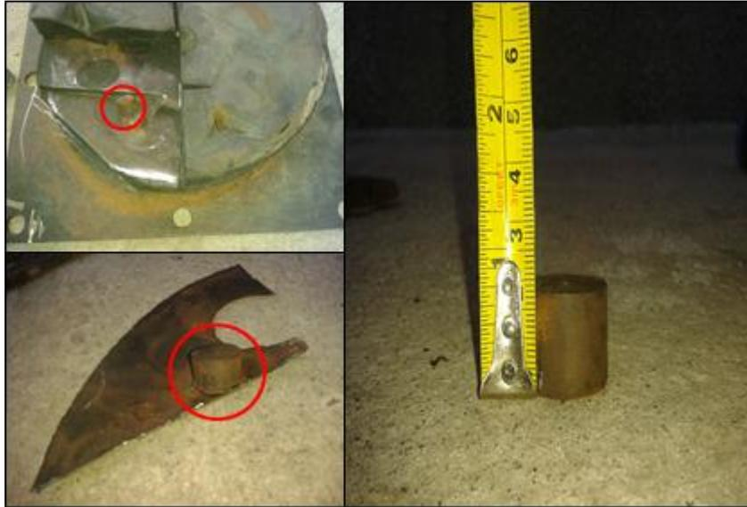
**Figura 108: Varilla utilizada como separador entre las láminas de refuerzo 1 y 2.**
