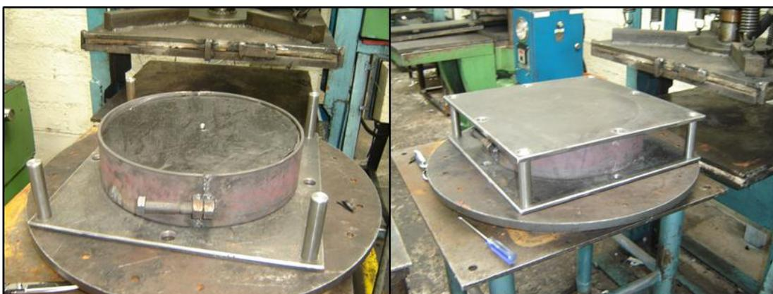
**Figura 118: Colocación del molde exterior y la capa de recubrimiento / colocación y fijación de la placa superior del aislador.**
