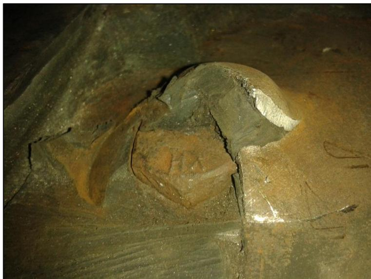
**Figura 109: Rotura presente en la lámina 2 de refuerzo.**
