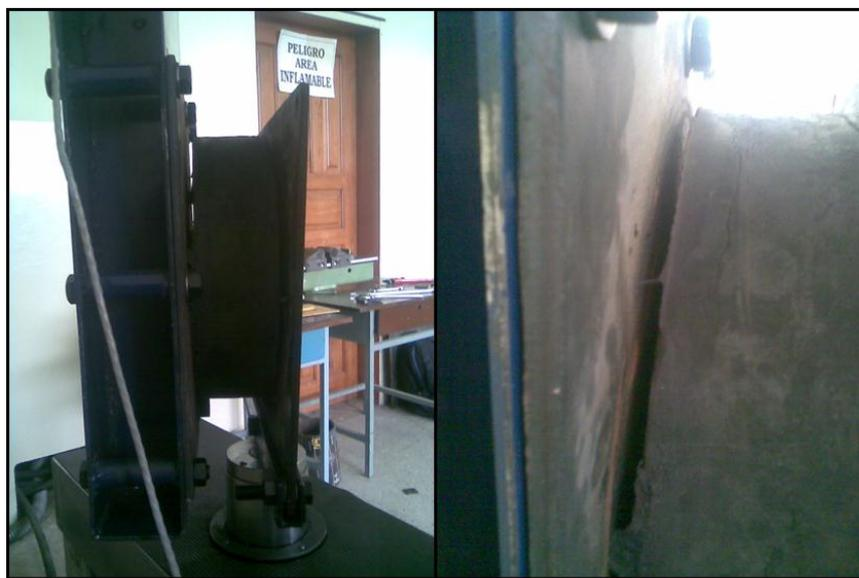
**Figura 103: Falla presentada en el Aislador antes de ser ensayado.**
