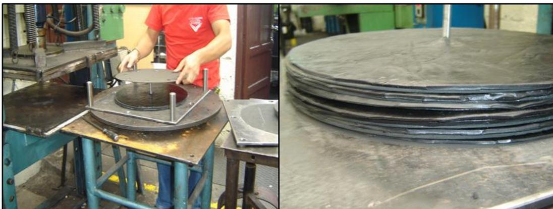
**Figura 117: Colocación de las láminas de caucho y las placas de refuerzo alternadamente.**
