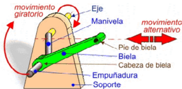
Figura 3.11: Esquema mecanismo biela-manivela
