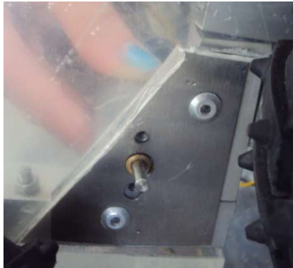
Figura 83. Placa de sujeción de los motores DC a la estructura
