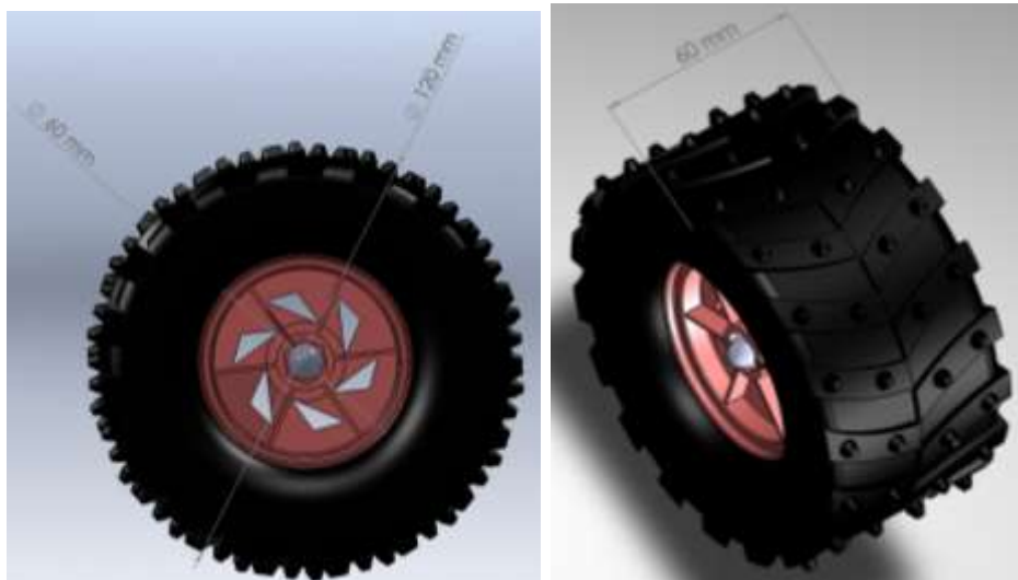
Figura 24. Dimensiones de la rueda de locomoción
