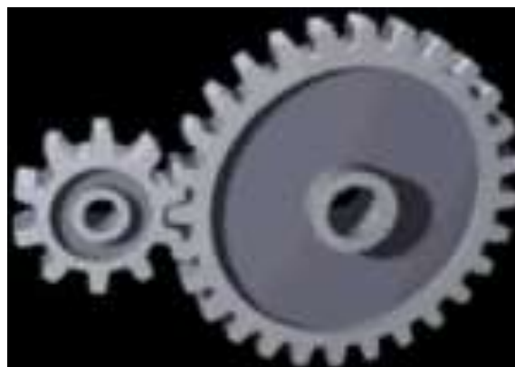
Figura 21. Transmisión por piñón
