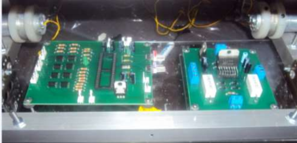
Figura 115. Ubicación de la placa de control de motores DC y control del robot en el vagón posterior
