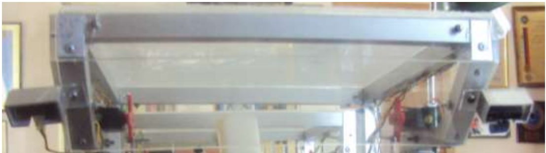
Figura 101. Sujeción del soporte del sensor infrarrojo.
