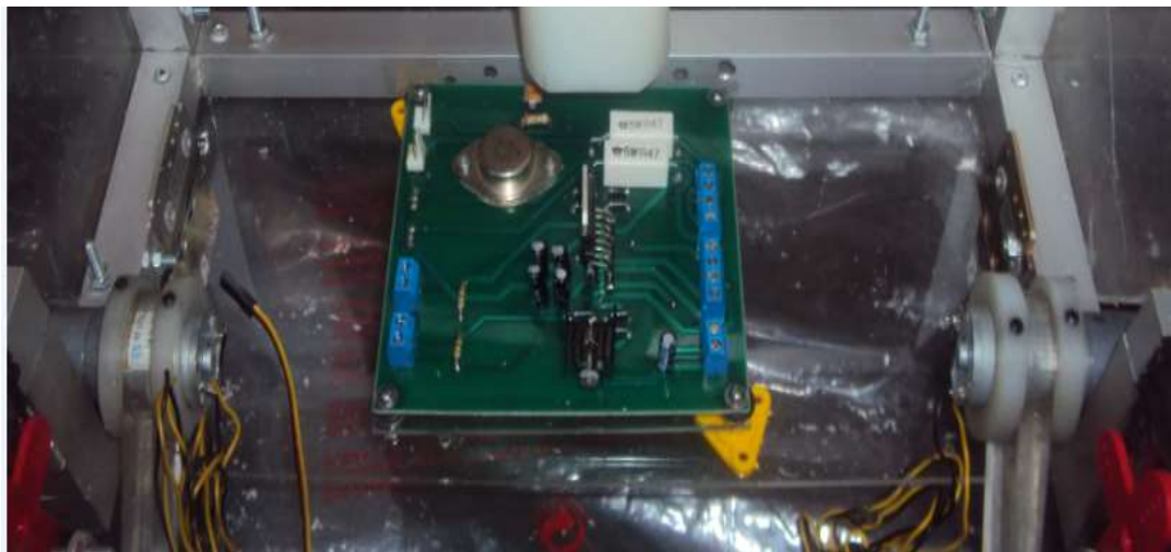
Figura 113. Aislamiento de las placas PCB con acrílico
