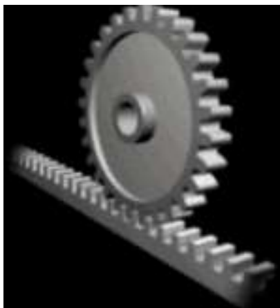
Figura 22. Transmisión por piñón- cremallera
