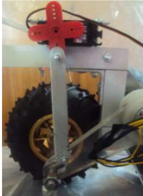
Figura 95. Mecanismo de la rueda móvil
