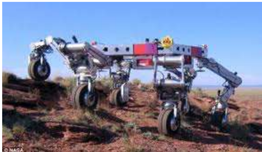
Figura 9. Ejemplo de un robot con piernas y con rueda, atravesando un terreno irregular con obstáculos sin dificultades.
