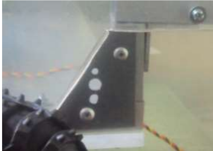
Figura 83. Placa de sujeción de los motores DC a la estructura
