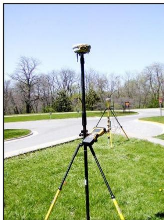
Figura. 3.16. Sistema GNSS Trimble® R8.
