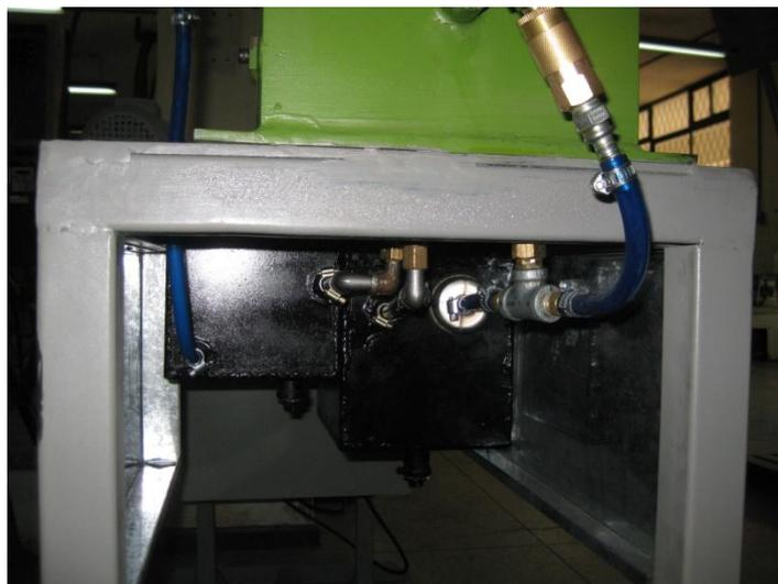
**Figura 6. 7 Depósitos de lubricación y refrigeración**
