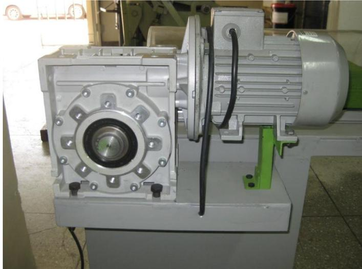
**Figura 6. 2 Motorreductor**
