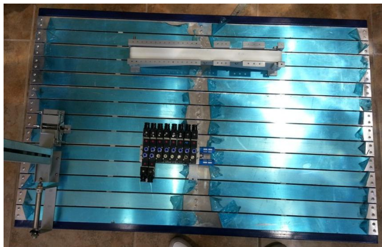
Fig 50. Mesa de montaje terminada.
