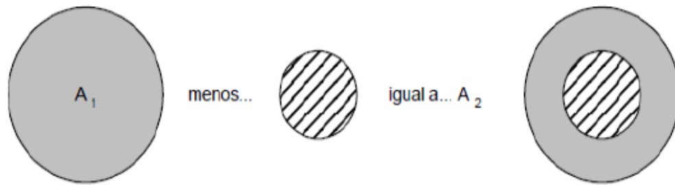
Fig 8. Diferencia entre las secciones efectivas de un cilindro
