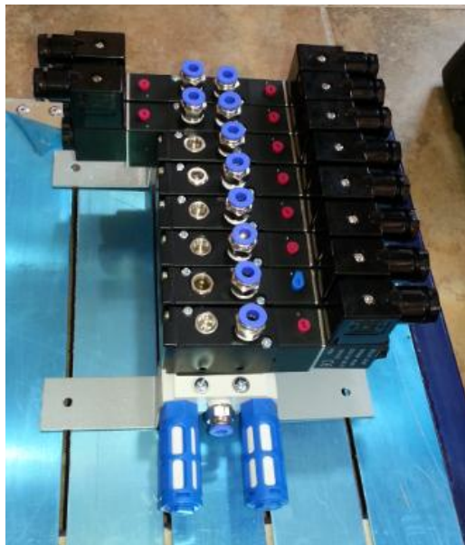
Fig 135. Soportes manifold manufacturados.
