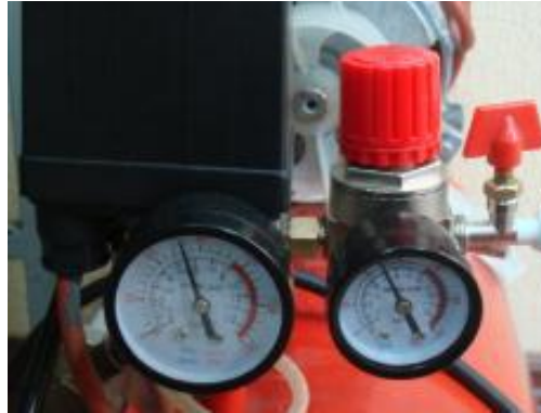
Fig 232. Válvula de Paso del Compresor
