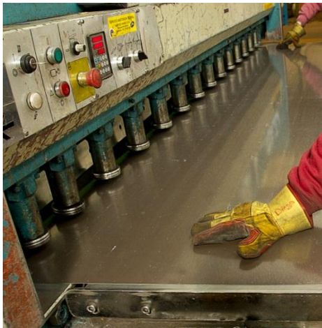
Fig 46. Corte cizalla automática
