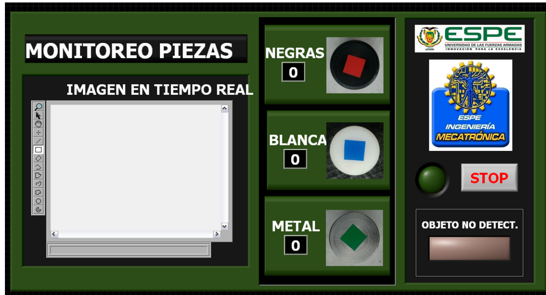
Fig 215. HMI en LabVIEW 2011 de sistema de conteo de piezas
