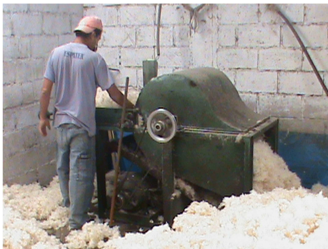
Figura 2. Máquina Mezcladora de la materia prima
