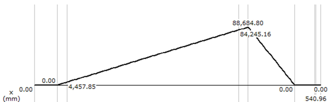
Figura 66. Diagrama de momento flector del eje de cilindro de salida plano x-y.
