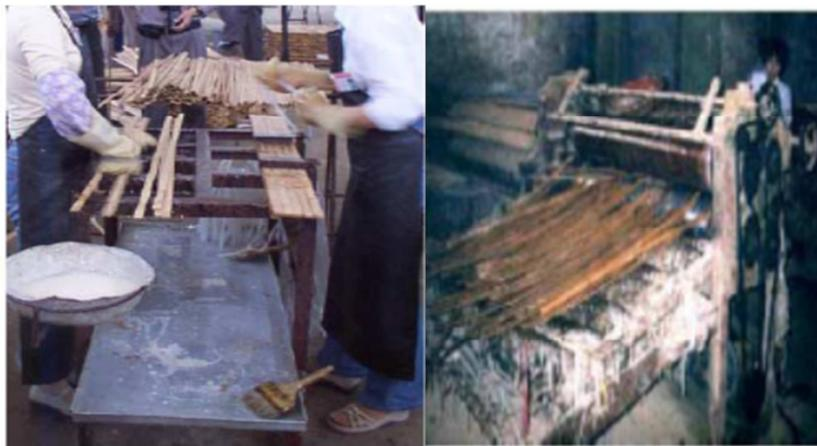
**Fig. 1 Impregnación de Resina de Forma Manual**
