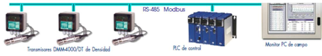
**Fig. 130 Representación de bus de campo del sensor de densidad**
