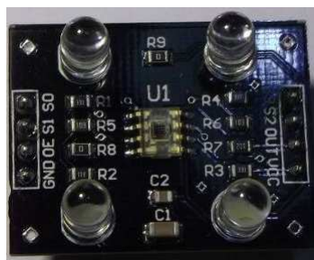
Ilustración 48. Fotografía Real del Sensor de Color Implementado.
