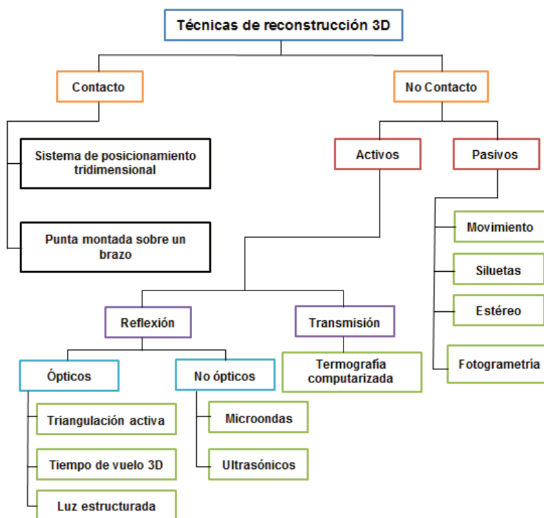
Figura 2. Esquema de los principales métodos de digitalización tridimensional.
