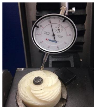
Figura 4.45: Medidas tomadas con el reloj comparador.
