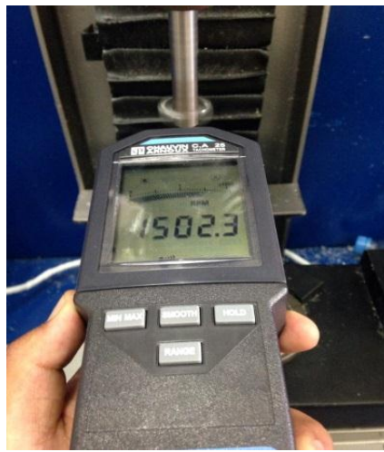
Figura 4.42: Pruebas de velocidad del husillo.
