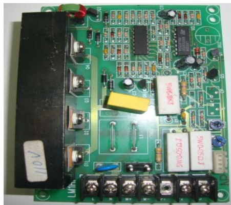
Figura 3.7: Tarjeta LM-1hp control de PWM
